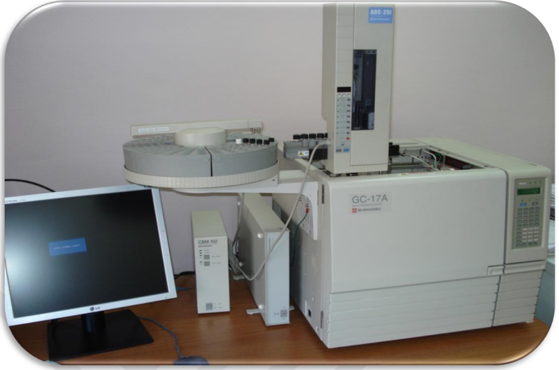
Resim 2.1. SHIMADZU GC 17 model gaz kromatografi cihazı
