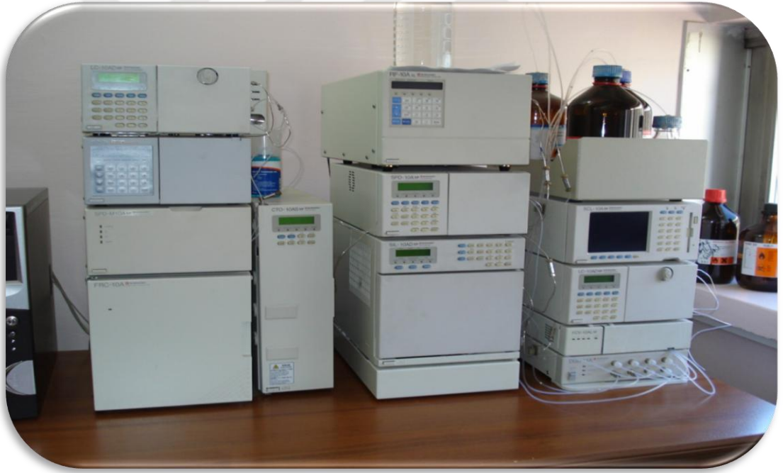
Resim 2.3. CECİL 1100 model yüksek performanslı sıvı kromatografi cihazı
