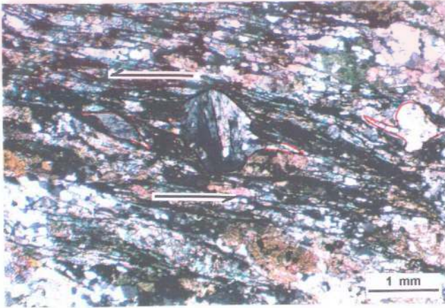
Foto 2.28. Fillitik-milonitik bir kayacın ve içindeki kayma yönü göstergelerinin mikroskopik görünümü. Bezirgan derenin yaklaşık 800 m KB'sı, Ç.N. x32.
