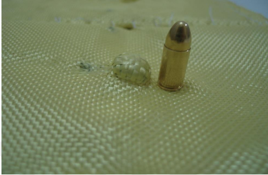
Şekil 6.4 Atış sonucu merminin malzeme üzerindeki aldığı yol
