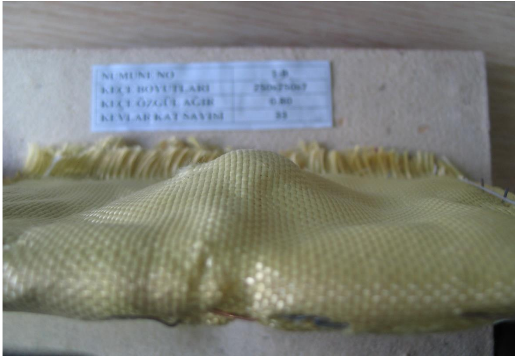
Şekil 6.1 Merminin kevlare yaptığı basınç sonucu
