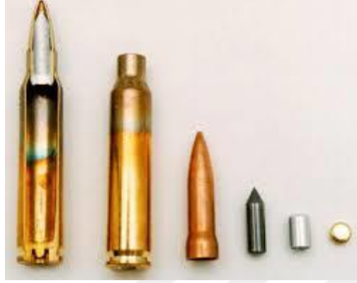
Şekil 4.1. Mermi ve Penetrator Örnekleri
