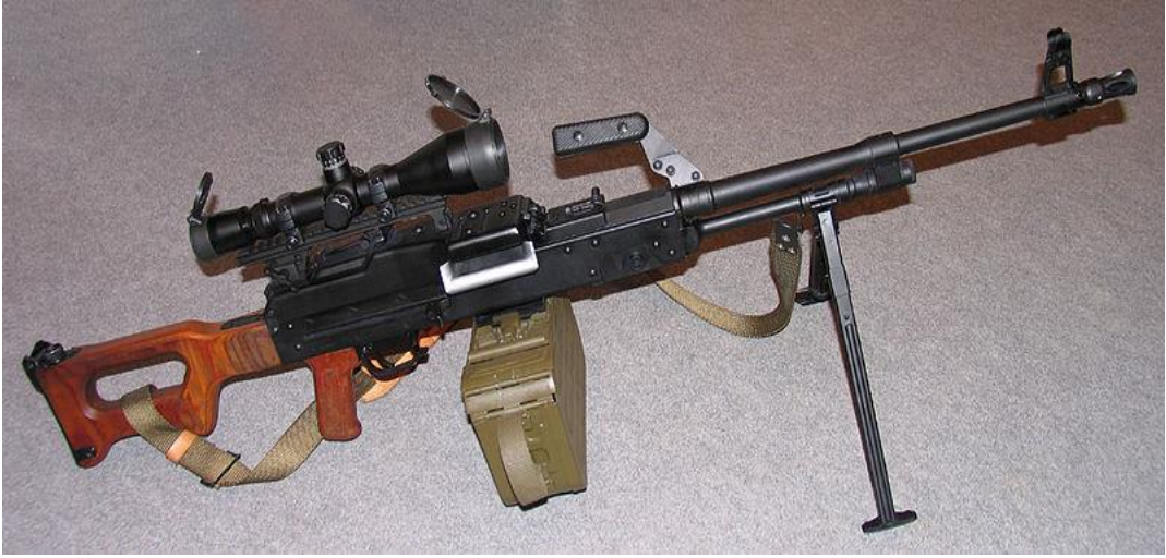
Şekil 5.15 7.62 mm Pkms (Bkc) Makineli Tüfek (Bixi)
