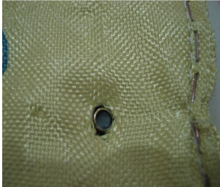
Şekil 6.3. Mermi kompozit malzemedan geçmemiştir.
