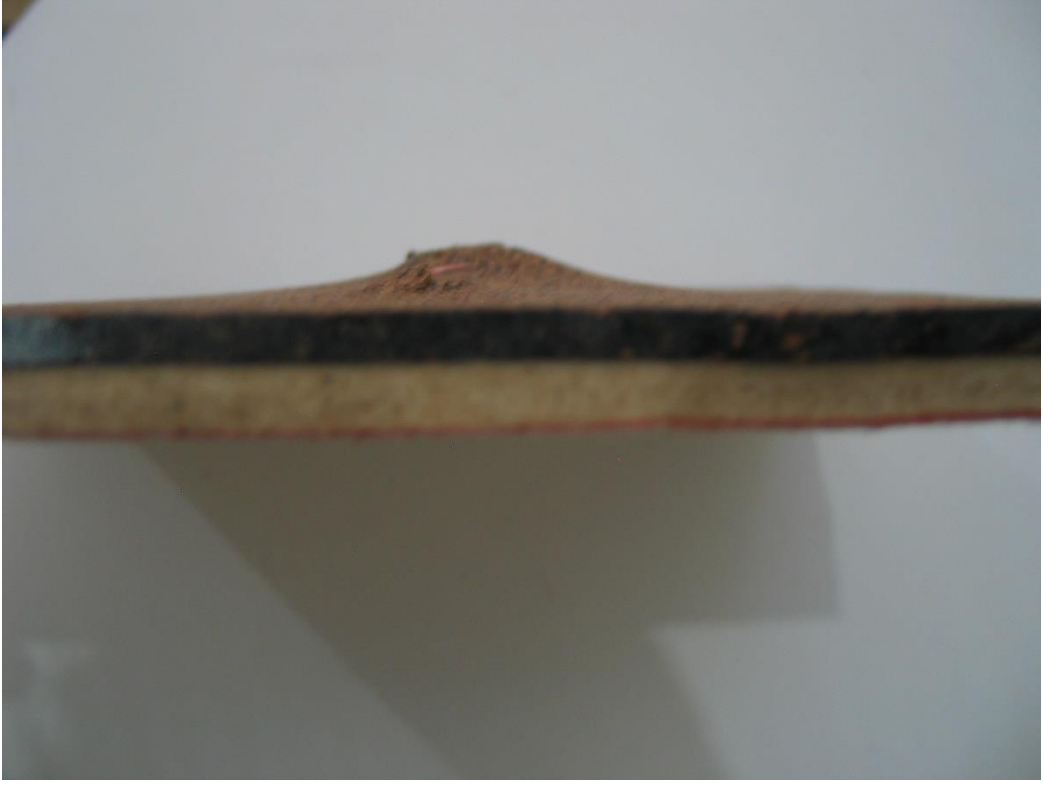
Şekil 6.6 Mermini Mantar üzerinde yaptığı basıncın etkisi
