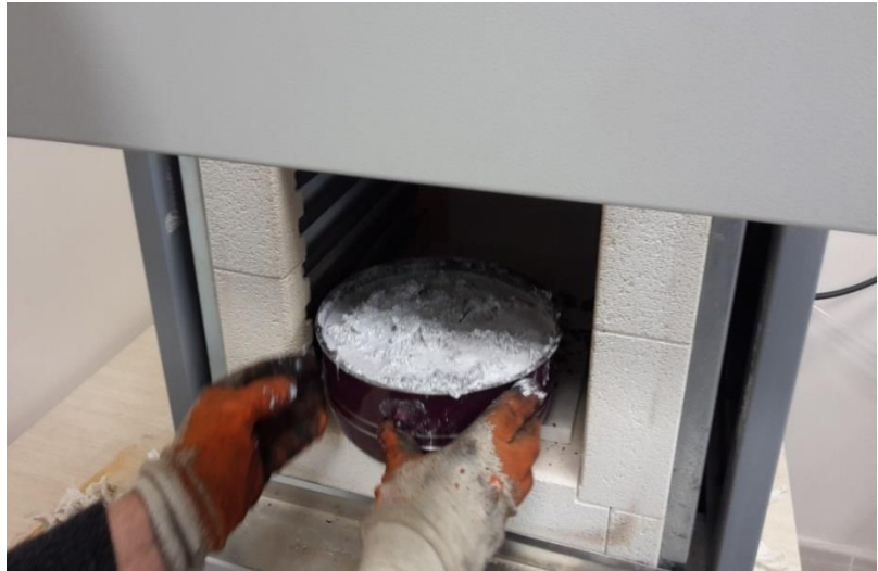
Şekil 5.18 Macunun fırınlama işlemi
