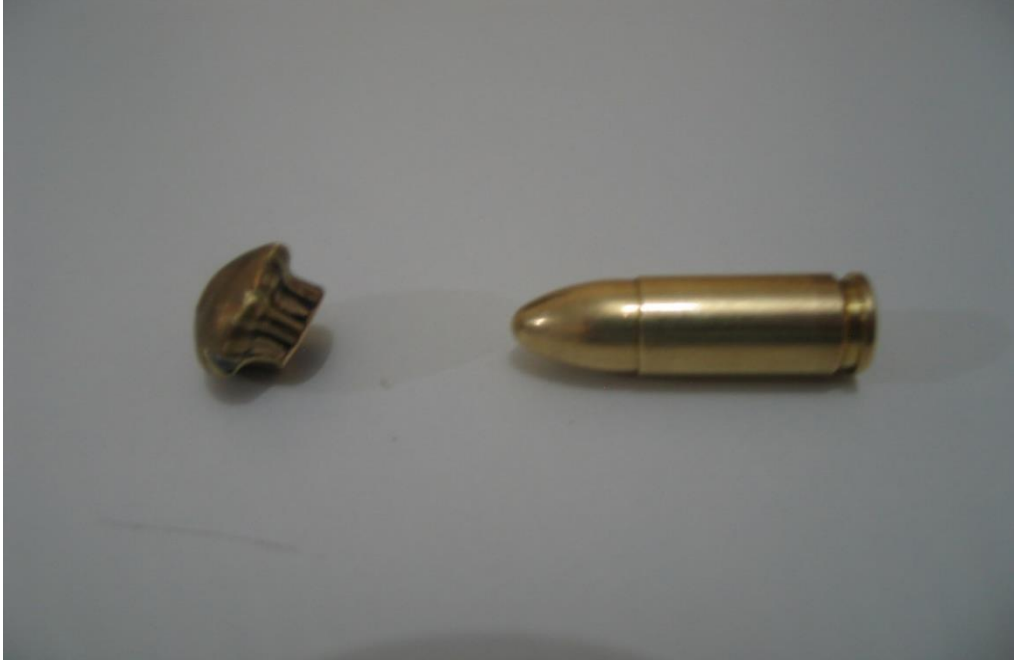
Şekil 6.8 Merminin kompozit malzemeye çarpma öncesi ve sonrası halleri
