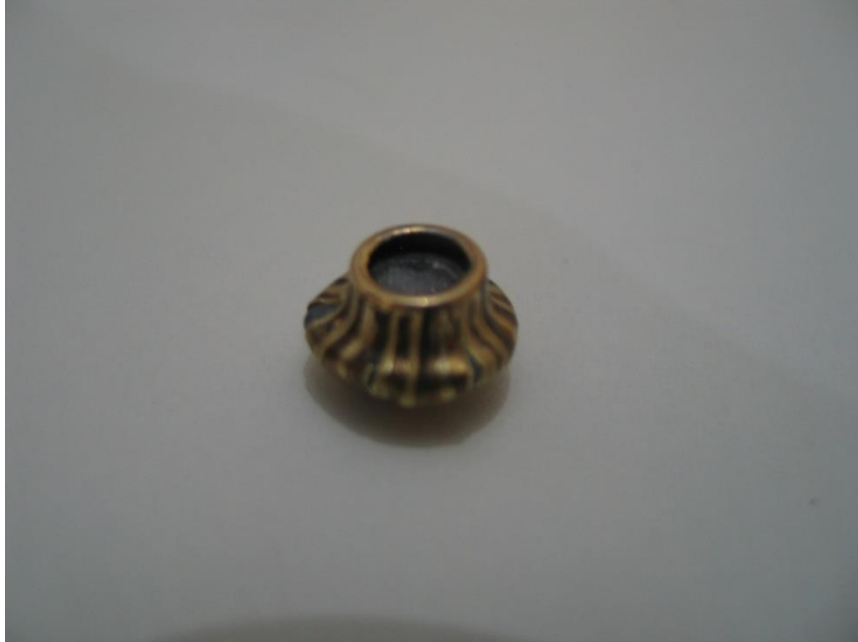
Şekil 6.7. Merminin kompozit malzemeye çarpması sonucu hali
