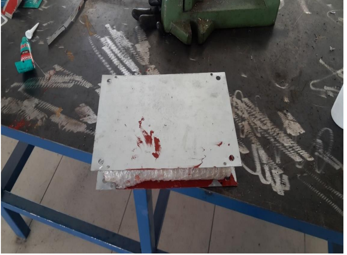
Şekil 5.19 Hazırlanan kompozit malzemenin atış öncesi son hali
