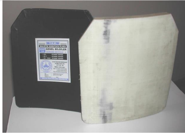
Şekil 2.3 Kompozit Yelek Zırh Plakası.
