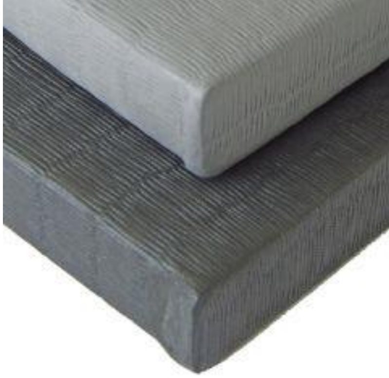
Şekil 5.13 Polietilenden oluşmuş malzeme
