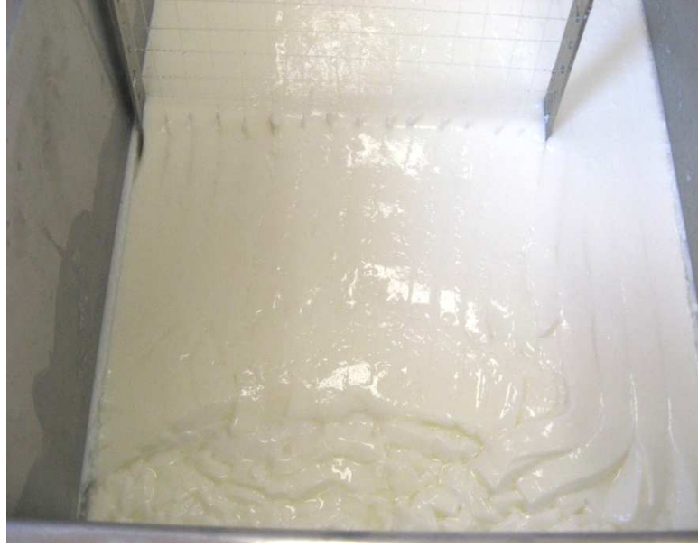
Şekil 3.6. Pıhtı kırımı sonucu oluşan küp şeklindeki yapı
