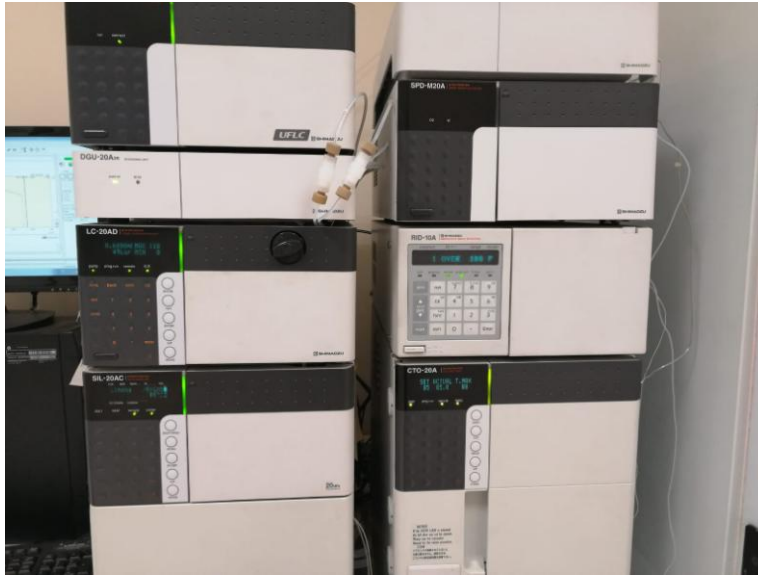
Şekil 3.2. Akdeniz Üniversitesi, Mühendislik Fakültesi, Gıda Mühendisliği Bölümünde bulunan Shimadzu marka, LC 20A Serisi HPLC cihazı
