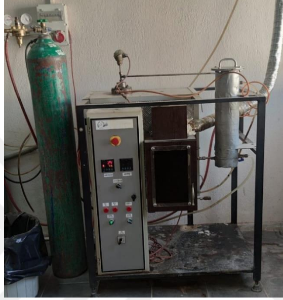
Resim 3.1 Deneyde kullanılan piroliz cihazı.
