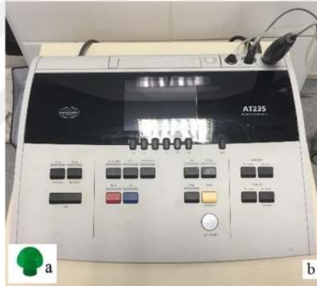
Şekil 3.2. 13mm mantar şekilli lastik prop ucu (a), İnteracoustics AT235h® timpanometre cihazı (b).
