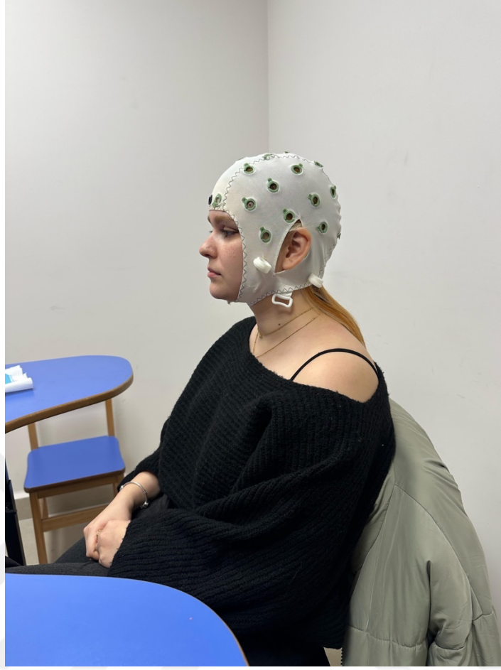
Resim 3.2: 32 kanallı EEG başlığının takılması
