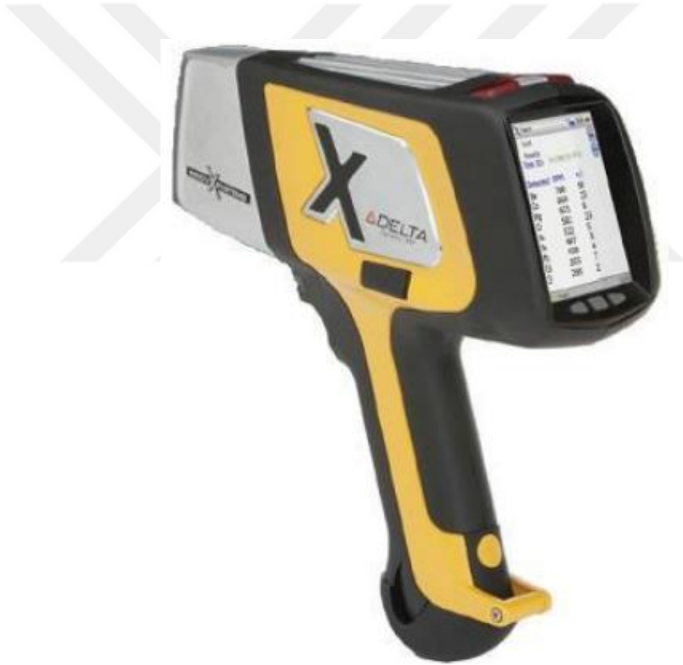
Şekil 3.6. Batman Üniversitesi Arkeometri Anabilim Dalı bünyesinde bulunan Taşınabilir Enerji Dağılımlı X-Işınları Floresan Spektrometresi (P-XRF)
