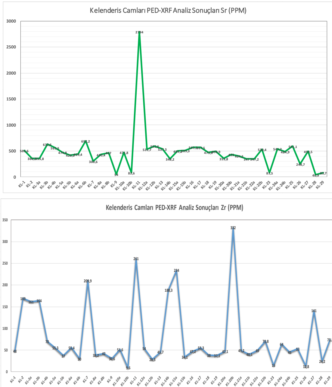
Şekil 4.9. Kelenderis cam örneklerinin PED-XRF analizi Stronsiyum (Sr) ve Zirkonyum (Zr) içeriklerine göre gruplandırılması.
