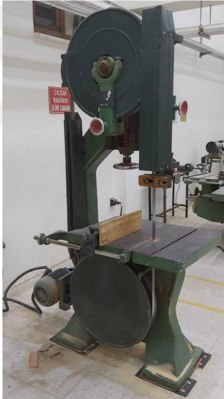
Şekil 3.13 Kemiklerin parçalanarak deney numunelerinin hazırlandığı dikey şerit testere.
