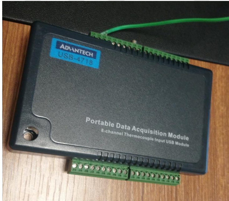
Şekil 3.4 Sıcaklık ölçümünde kullanılan 8 kanallı veri alma modülü.
