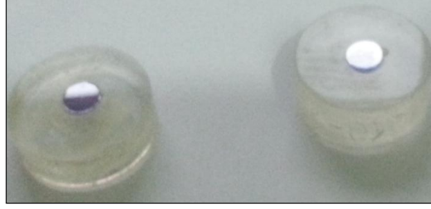
Şekil 6.4. Bakalite alındıktan sonra zımparalanmış ve parlatılmış numuneler.
