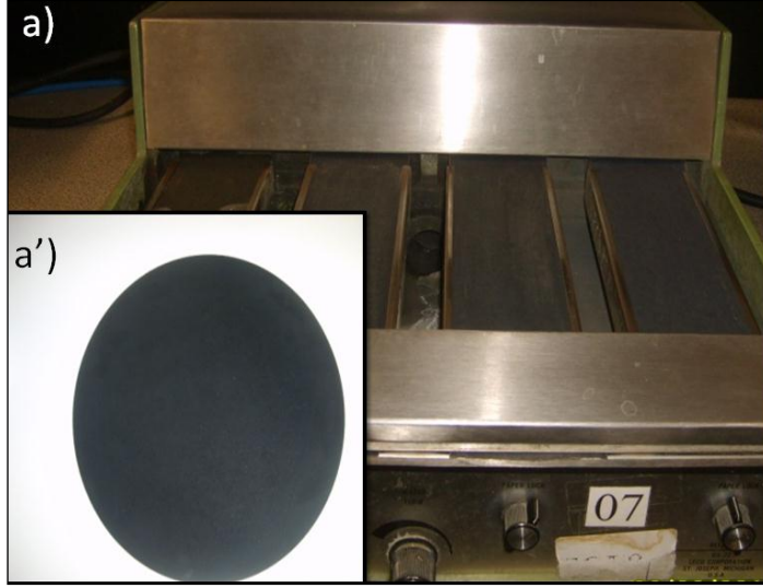
Şekil 6.6. a) Manuel zımparalama donanımı, a') parlatma çuhası.
