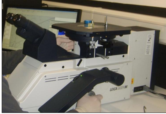
Şekil 6.11. Optik mikroskop (Leica-MEF4M).
