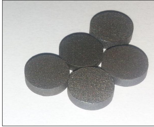
Şekil 6.3. Tel erozyon işleme yöntemi kullanılarak kesilen disk şeklindeki numuneler.
