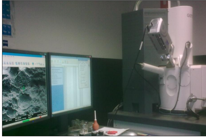
Şekil 6.14. Taramalı elektron mikroskobu (Field-Emission SEM ZEISS SUPRA 40 VP).
