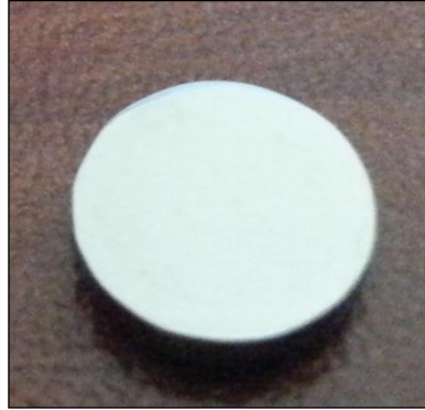
Şekil 6.9. XRD analizi için hazırlanmış numune örneği.
