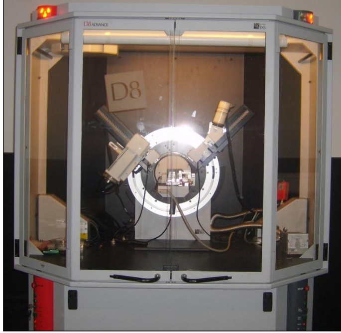
Şekil 6.10. X-ışını difraktometresi (Bruker D8 Advance).
