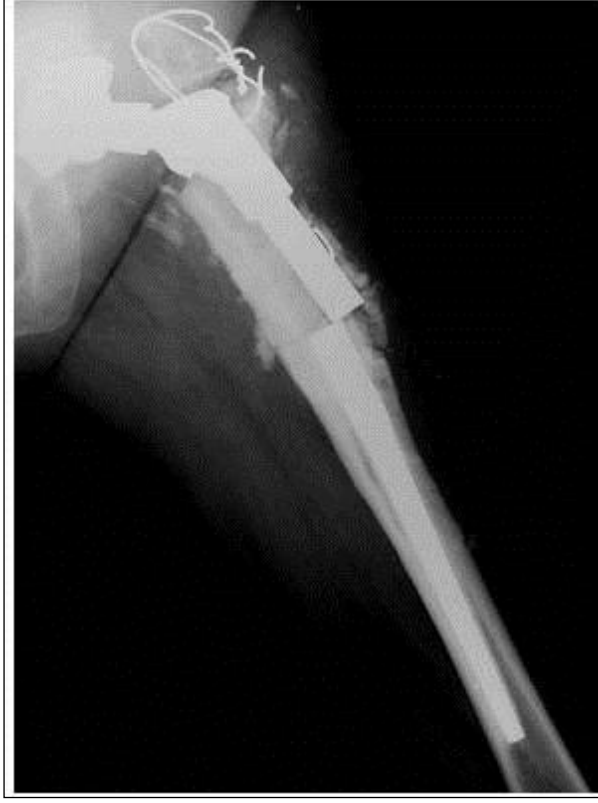
Şekil 3.7. Total kalça protezinin sap kısmının kırıldığını gösteren sol kalçaya ait anteroposterior radyografi (Buttaro et al.'dan 2007) (“Şekil 3.7” için telif hakkı sahibi Elsevier’den “3575020777696” numaralı yeniden kullanma izni alınmıştır.)
