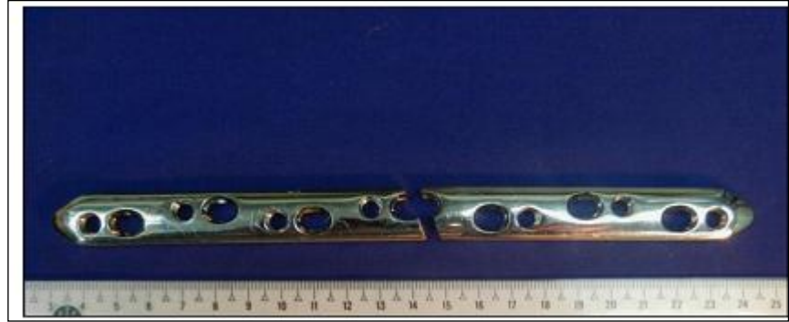
Şekil 3.9. Kırılmış kilitli baskı plakası (Marcomini et al.'dan 2014). (“Şekil 3.9” için telif hakkı sahibi Elsevier’den “3575020431422” numaralı yeniden kullanma izni alınmıştır.)
