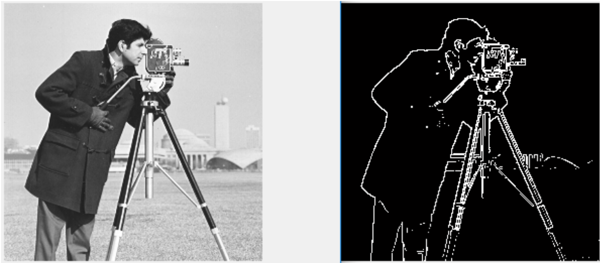
Şekil 2.2 Orijinal görüntü ve Roberts işleci uygulanmış hali
