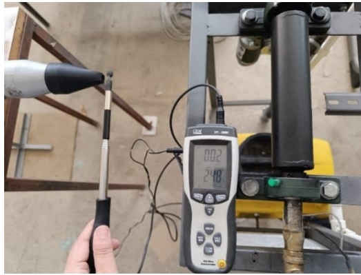
Şekil 3.3: Anemometre ile ölçüm yapılması.
