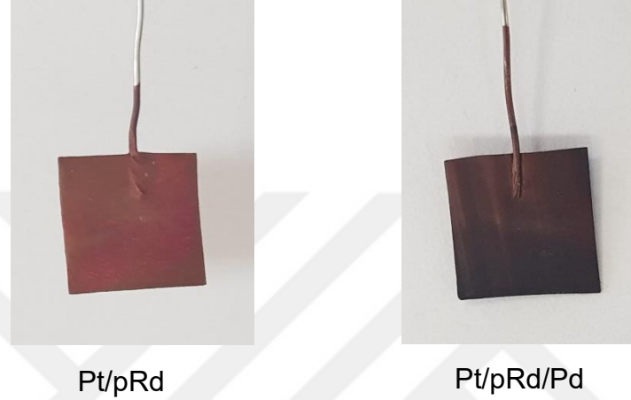
Şekil 4.9. 200 segment sonunda Pt yüzeyinde hazırlanmış Pt/pRd ve Pd modifiye edilmiş Pt/pRd/Pd yüzeylerin resimleri
