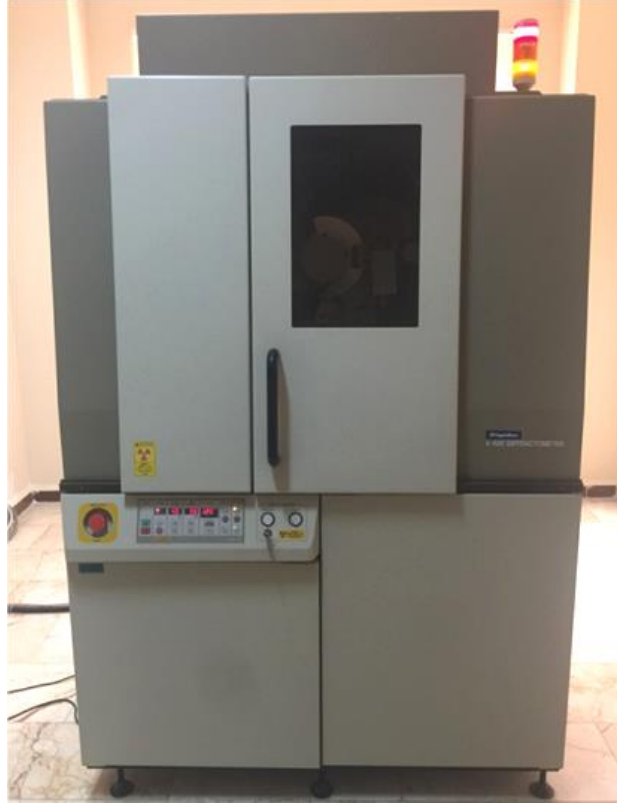
Şekil 3.5. XRD ölçümlerinde kullanılan test cihazı
