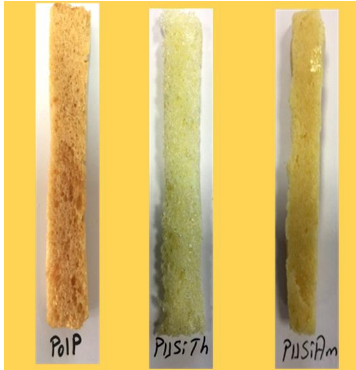
Şekil 4.39. PPPU, PUSiTh ve PUSiAm LOI Test numuneleri
