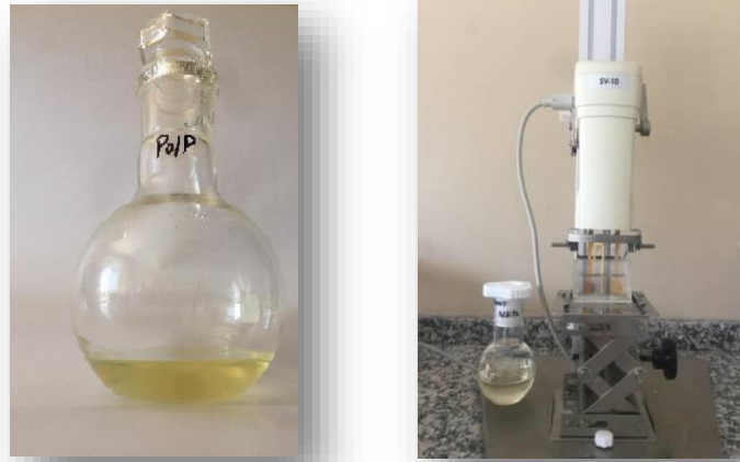
Şekil 3.14. Sentezlenen PolP ve vizkozite ölçümü
