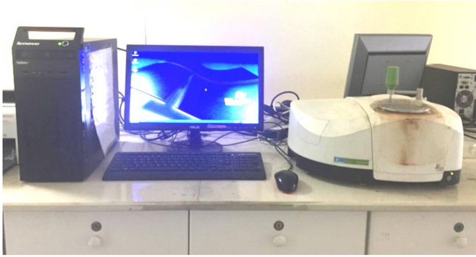
Şekil 3.1. FTIR ölçümlerinde kullanılan test cihazı
