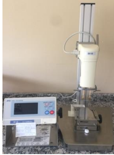
Şekil 3.2. Viskozite ölçümlerinde kullanılan test cihazı
