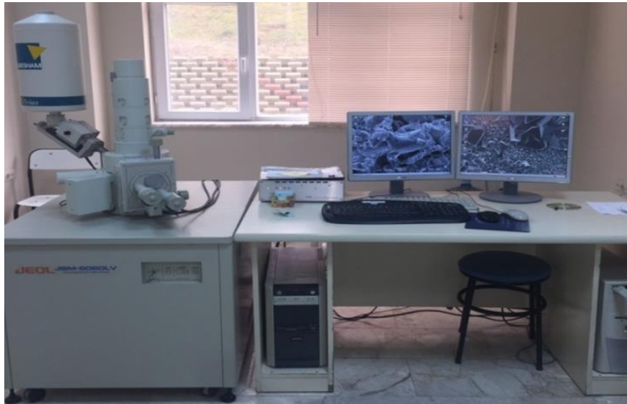
Şekil 3.6. SEM ölçümlerinde kullanılan test cihazı
