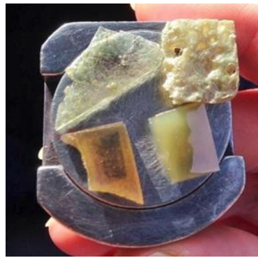
Şekil 4.25. Poliüretan köpük malzemenin altın kaplama işlemi
