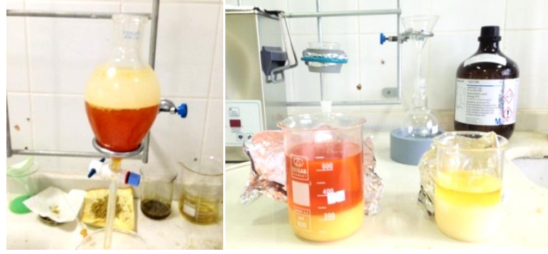
Şekil 3.13. Poliollerin nötrleştirme ve kurutulma işlemi
