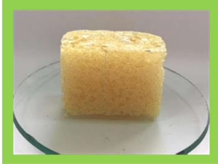
Şekil 3.23. PolP ile MDI'dan elde edilen rijit köpük PPPU
