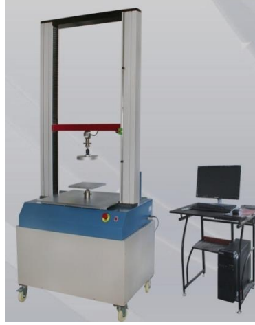
Şekil 3.10. Sıkıştırma (Kalıcı deformasyon) testi için kullanılan cihaz
