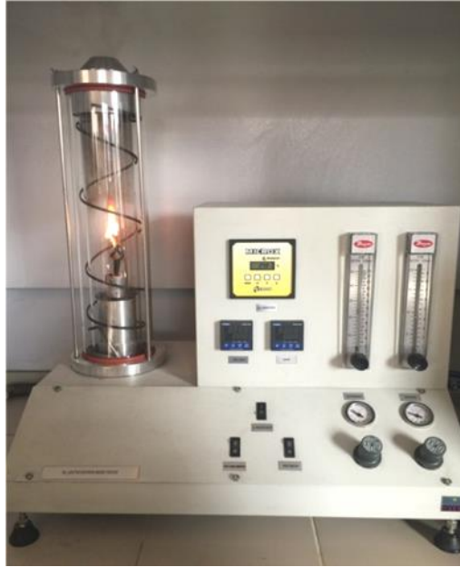
Şekil 3.9. LOI ölçümlerinde kullanılan test cihazı
