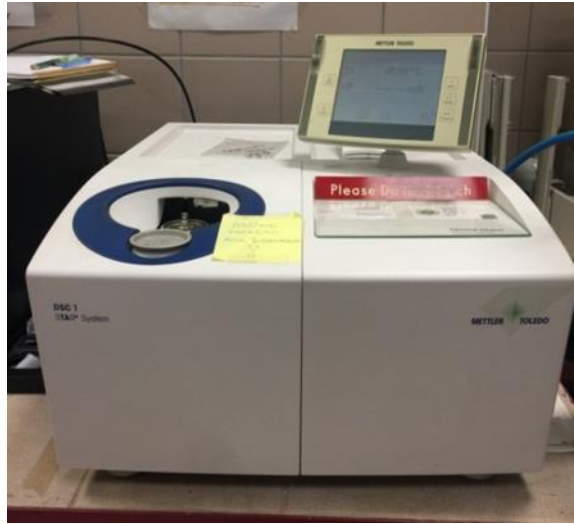
Şekil 3.7. DSC ölçümlerinde kullanılan test cihazı
