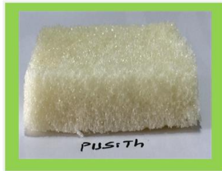
Şekil 3.25. PSiTh ile MDI'dan sentezlenen rijit köpük PUSiTh
