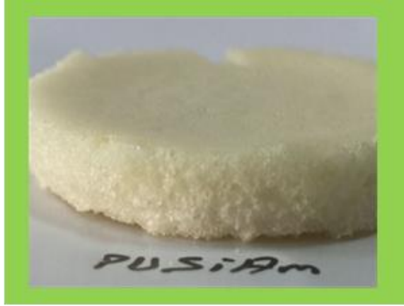
Şekil 3.27. PSiAm ile MDI rijit köpük PUSiAm
