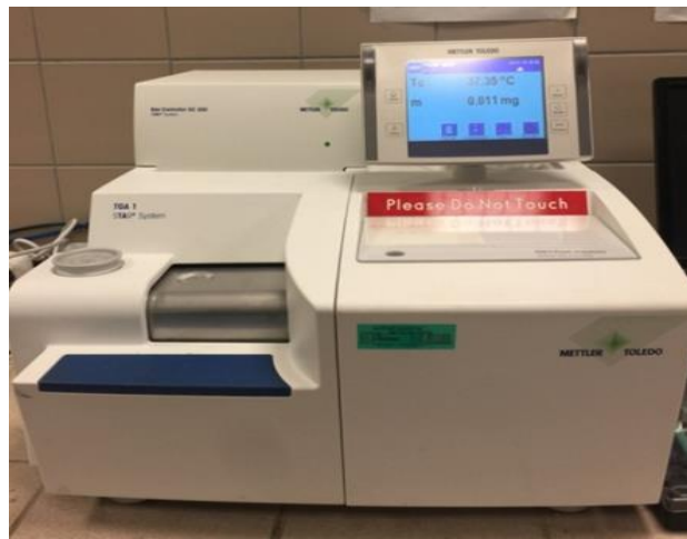
Şekil 3.8. TGA/DTGA ölçümlerinde kullanılan test cihazı
