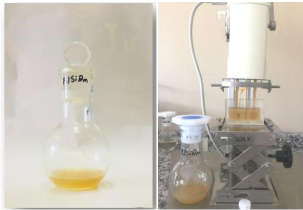
Şekil 3.18. Sentezlenen PSiAm ve viskozite ölçümü
