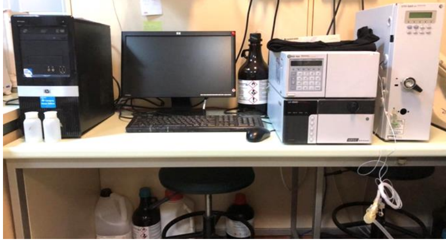
Şekil 3.4. GPC ölçümlerinde kullanılan test cihazı
