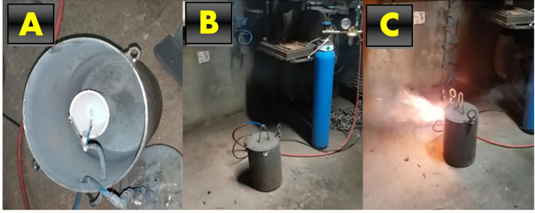
Şekil 3.3. Argon atmosferinde gerçekleştirilen SHS deneyleri: (A) Seramik pota içerisindeki reaktanlar, (B) SHS reaksiyonu öncesi ve (C) SHS reaksiyonu devam ederken.
