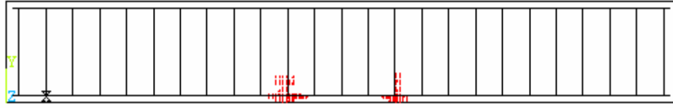
Şekil 6.12 K.Normal.20 kirişinin nümerik çözümlerinden elde edilen ilk çatlak durumu.
