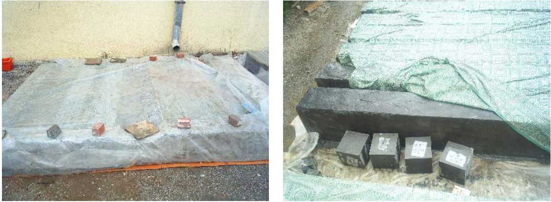
Şekil 5.5 Kiriş ve küp numunelerinin kür edilmesi
