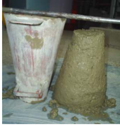
Şekil 5.2 Normal betonu için çökme deneyi
