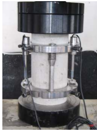
Şekil 5.6 Betonların elastisite modülü tayini
