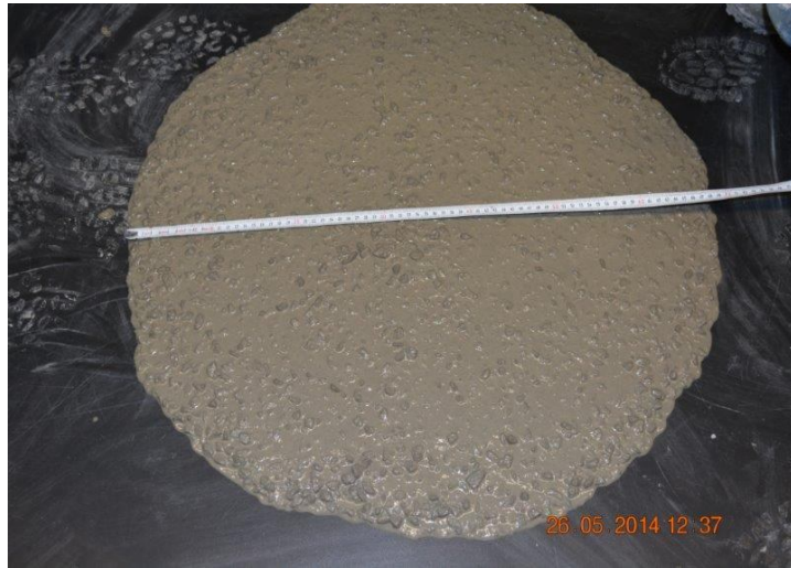
Şekil B.11 BA-D4 Yayılma Deneyi
