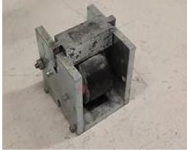
Şekil B.5 Klorür Geçirirnililiđi Deneyinde Kullanılan Yarma Aparatı
