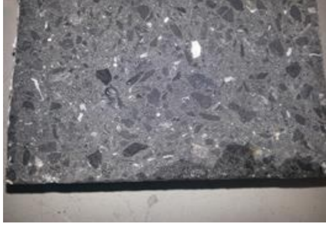
Şekil B.1 KT-D5 Basınç Altında Su İşleme Derinliği
