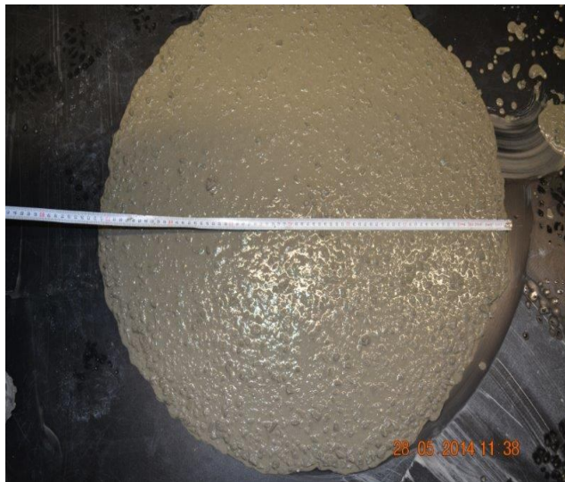
Şekil B.12 BA-D6 Yayılma Deneyi
