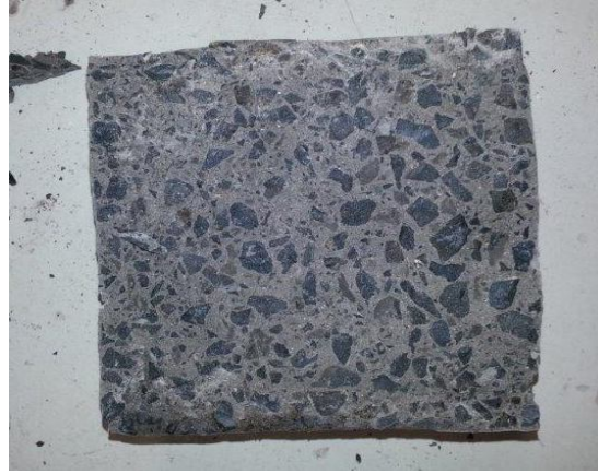
Şekil B.2 BA-D4 Basınç Altında Su İşleme Derinliği
