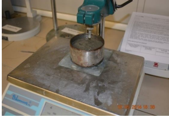
Şekil 1.11 Priz süresi deneyinde numune alımı
