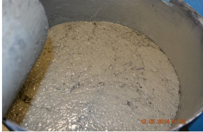
Şekil 3.3 Malzemenin betoniyerde karıştırılması
