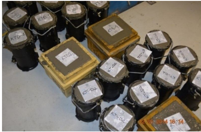
Şekil 3.4 Numune kalıpları şekil ve boyutları
