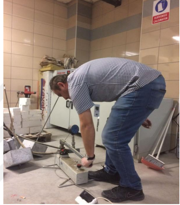
Resim 4.6. Hidrolik Yük Verilmesi
