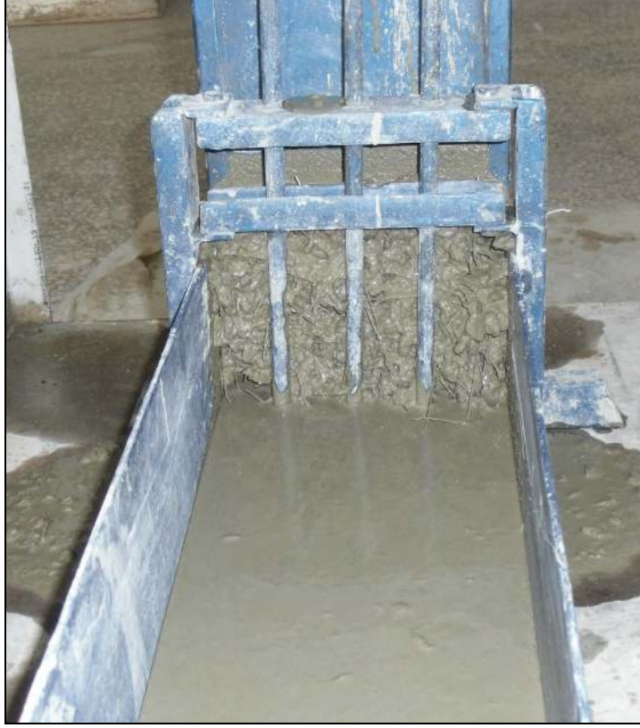
Şekil 3.2. Çelik lifli KYB' lerin L kutusu deneyi sırasında tıkanma oluşması
