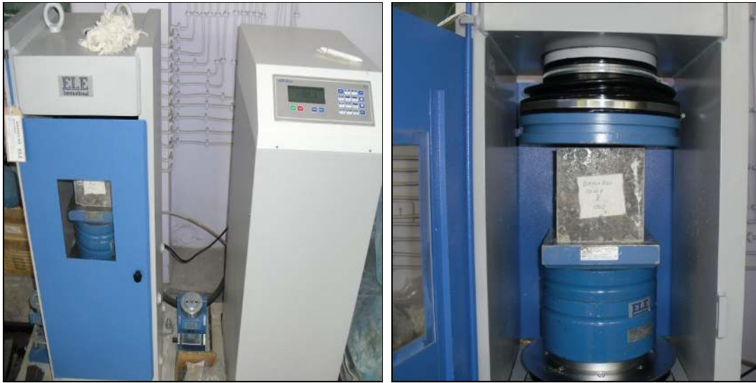
Şekil 2.5. Beton basınç dayanımı deneyi
