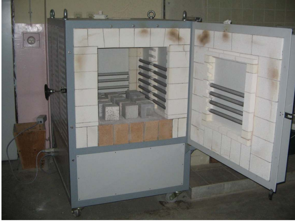
Şekil 4.9. Yüksek sıcaklık testlerinde kullanılan fırın
