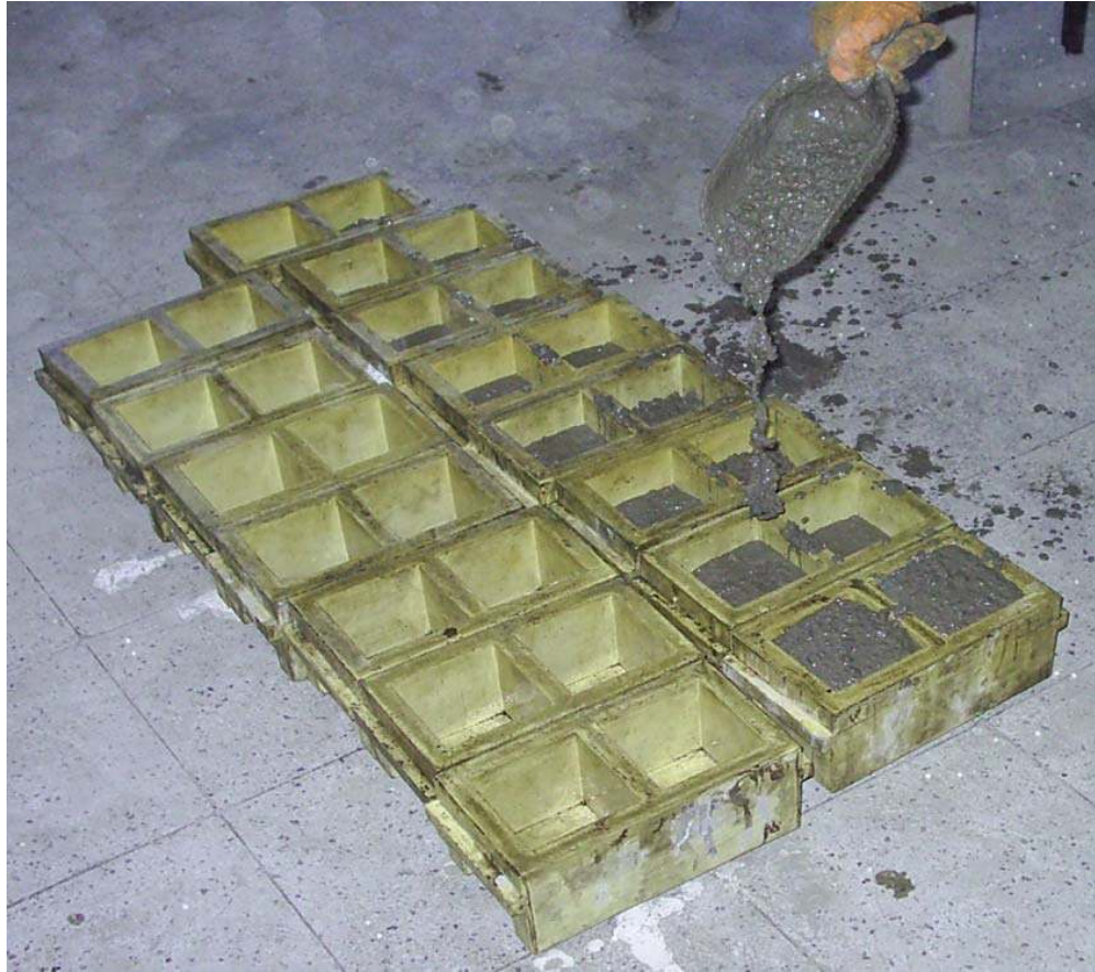
Şekil 4.2. KYHB'lerin kalıplara dökülmesi
