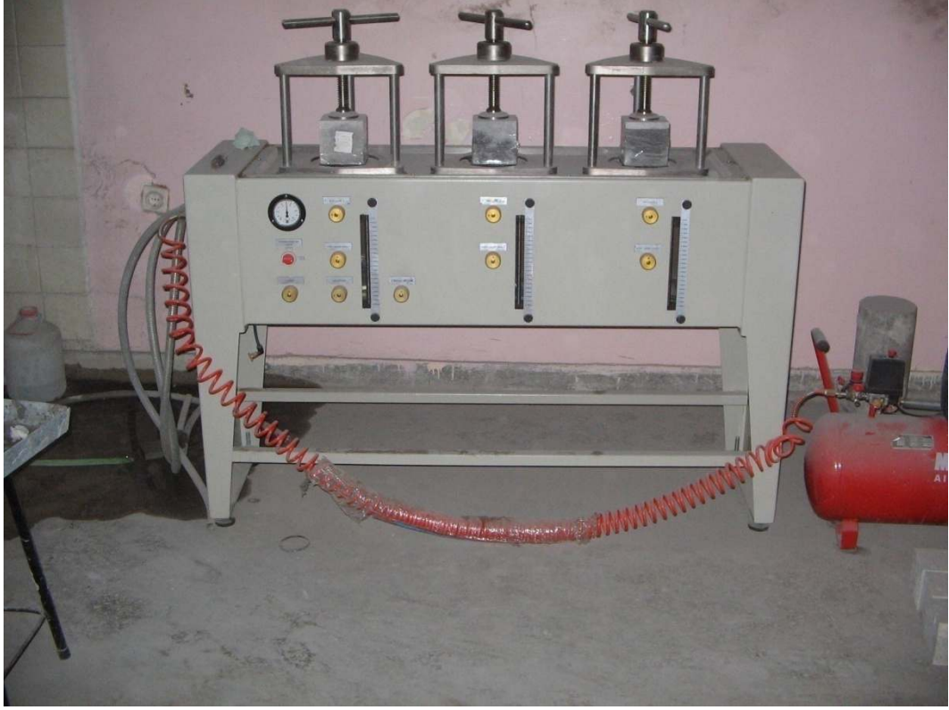
Şekil 4.10. Basınçlı su geçirimsizliği deneyi
