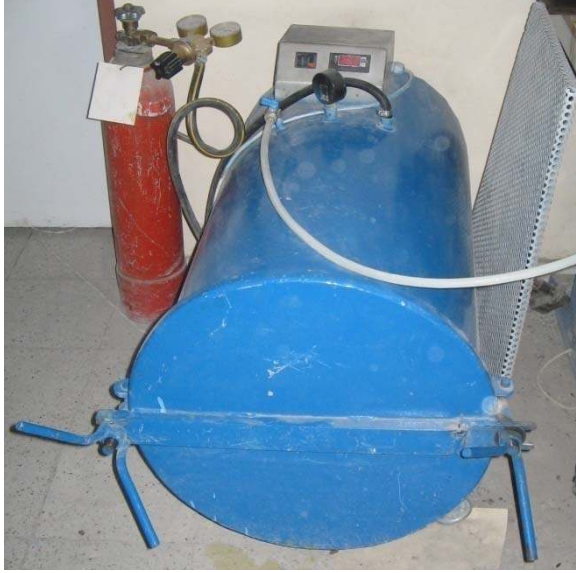
a) Hızlandırılmış karbonatlaşma tankı
