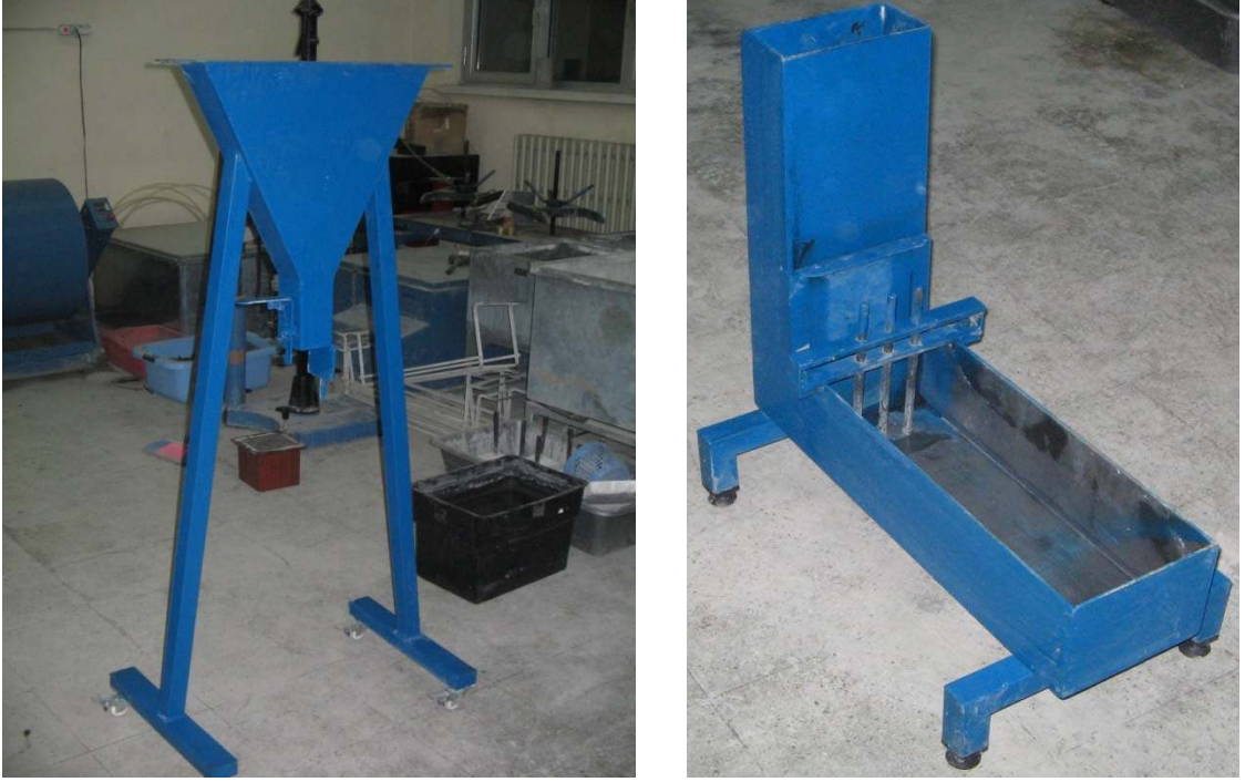
Şekil 4.4. Taze beton deneylerinden kullanılan V hunisi ve L kutusu.
