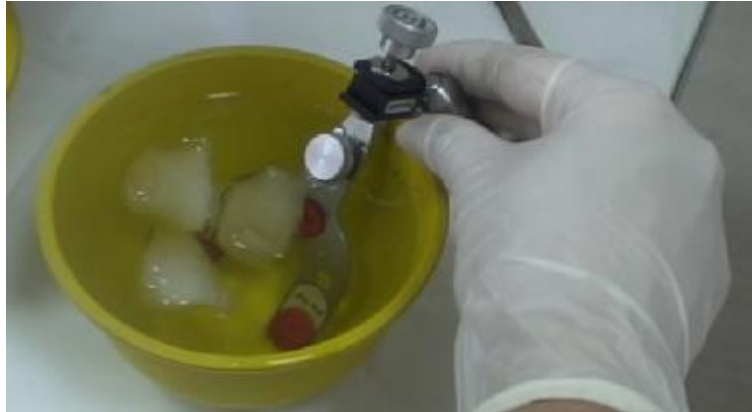
Şekil 3.10. Isırma çatalının buzlu suda soğutulması.
