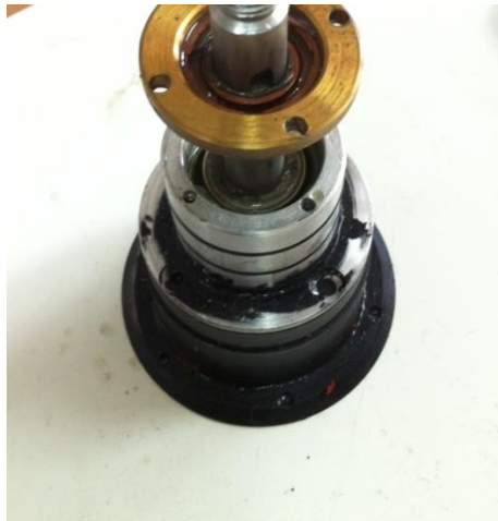
Şekil 9.15: İmalatı biten motor yatağı.
