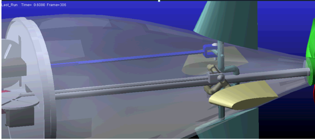
Şekil 5.4: Amudi dümen milinin sevk mili ile çakışması.
