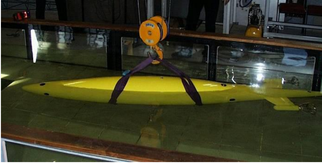
Şekil 1.8: SVA Potsdam’da yapılan kendinden hareketli sualtı test aracı [6].
