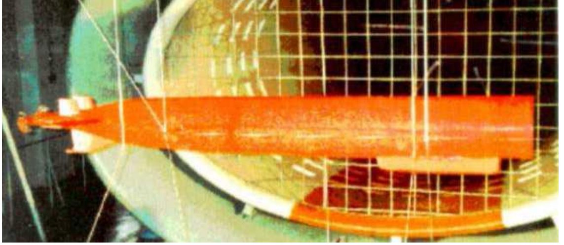
Şekil 1.6: Kanada'da yapılan rüzgar tüneli testinden görüntü [8].
