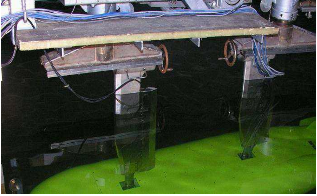
Şekil 1.2: SVA Potsdam (Almanya) kullanılmakta olan PMM cihazı.
