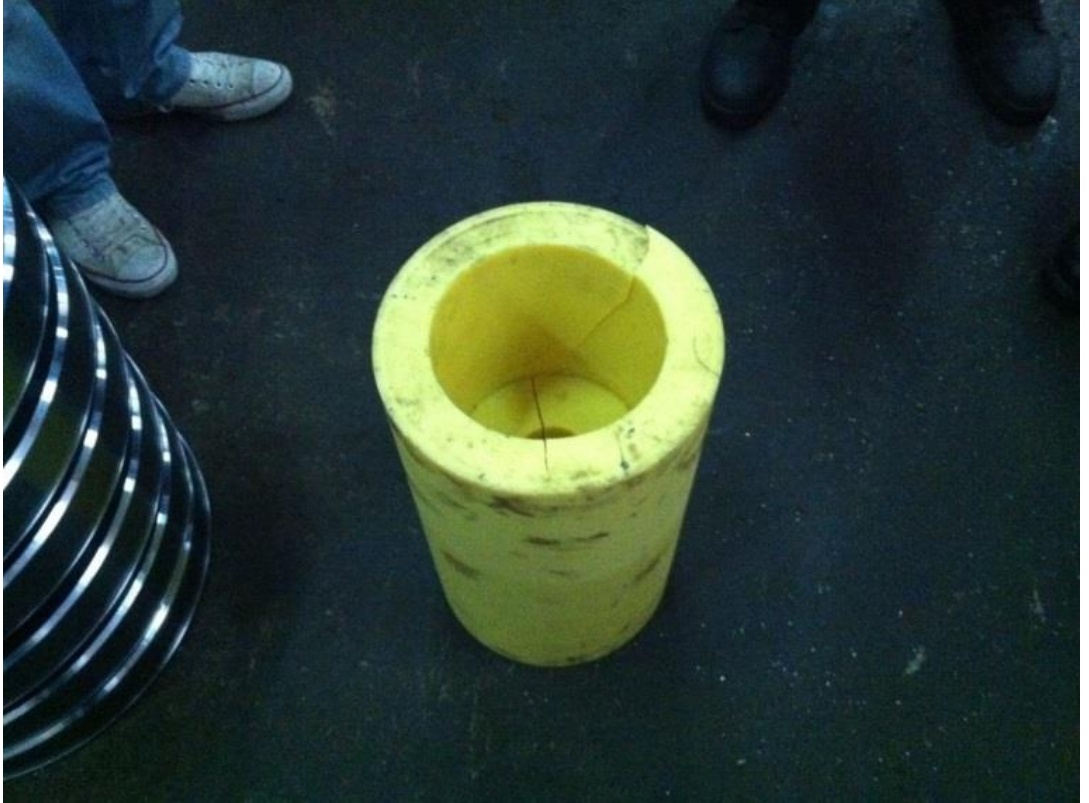
Şekil 6.10: İmalat sırasında kırılan kestamid parça.
