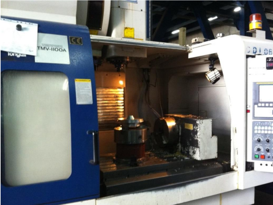
Şekil 6.5: İşleme Merkezi dikey delik delme pozisyonu.
