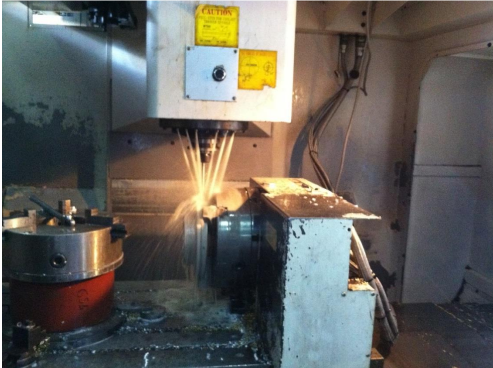
Şekil 6.7: İşleme Merkezi radyal yönde delik delme pozisyonu.
