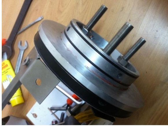
Şekil 9.13: Boru - K1ç arasındaki sızdırmazlık tertibatı için kullanılan flanş parçası.
