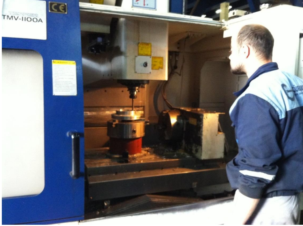
Şekil 6.6: İşleme Merkezi dikey delik delme pozisyonu.
