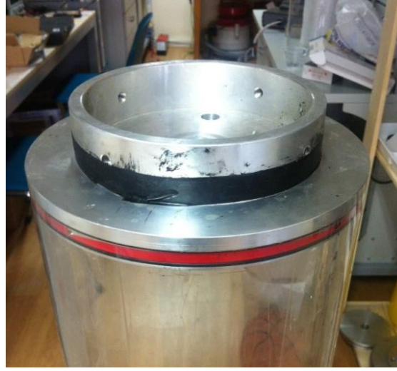
Şekil 9.11: Ön - Boru arasındaki sızdırmazlık tertibatı için kullanılan flanş parçası.
