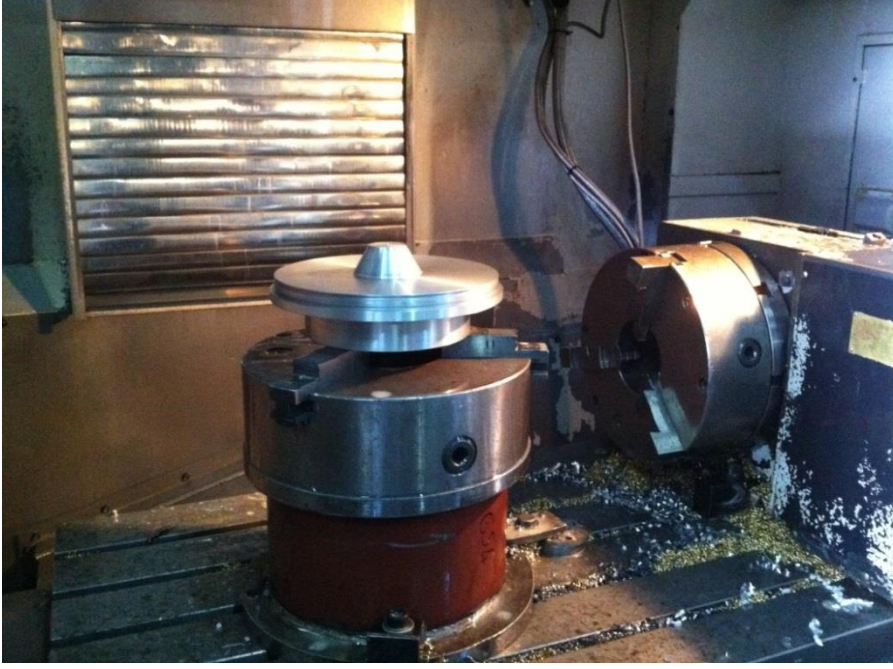
Şekil 6.4: İşleme Merkezi dikey delik delme pozisyonu.
