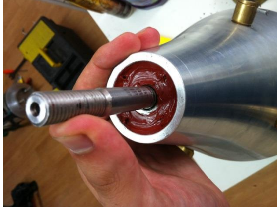
Şekil 9.8: Pervane milini yataklama yetersizliğinden dolayı eğilmesi ve sızdırma olasılığı.
