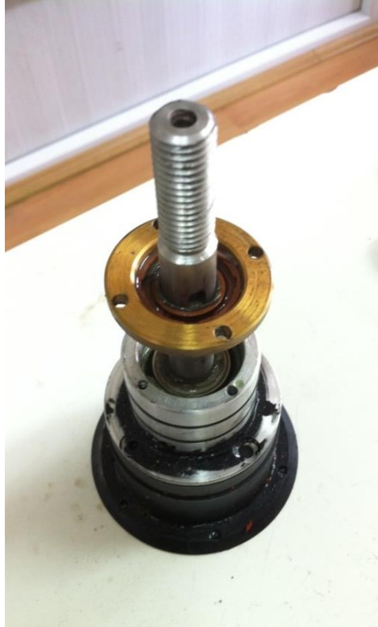
Şekil 9.2: Pervane mili sızdırmazlık.
