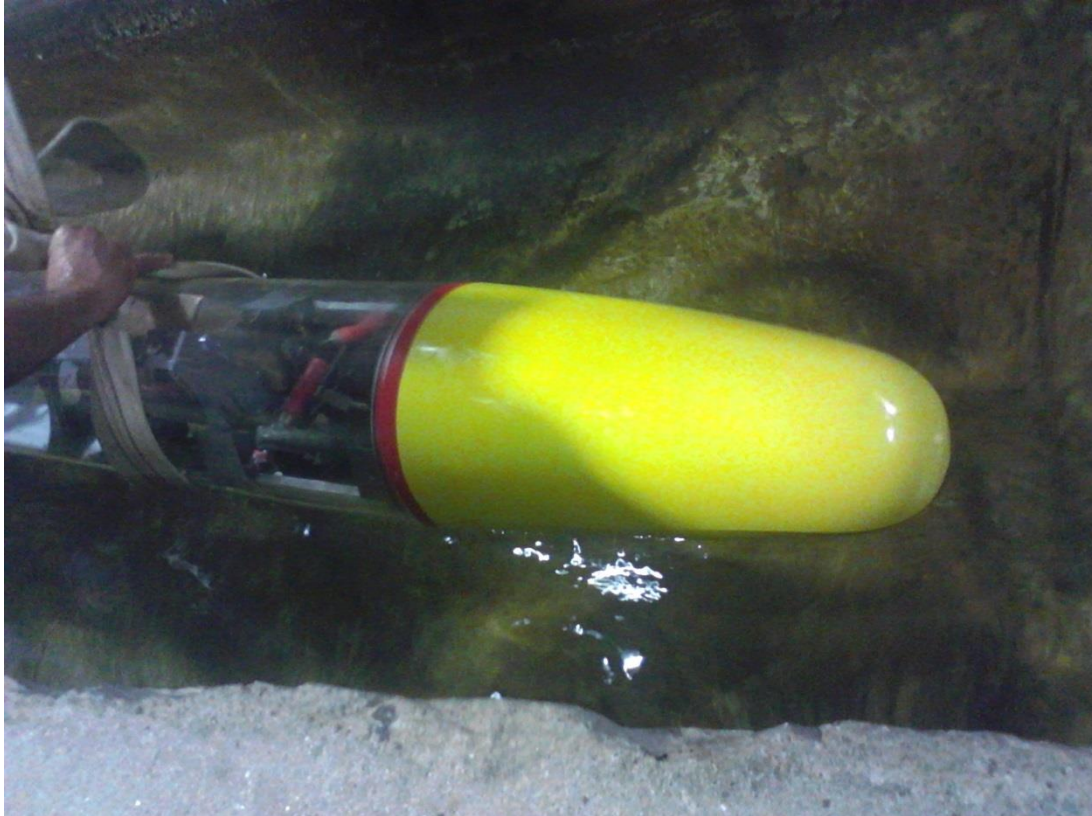
Şekil 9.26: Model denizaltı sızdırmazlık testi.
