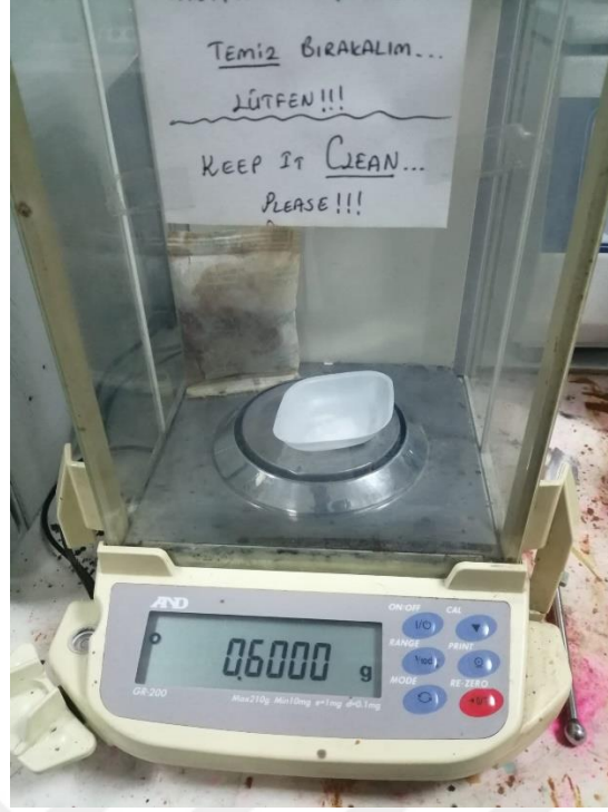
Şekil 2.1. Kimyasal malzemelerin hassas terazide tartılması.
