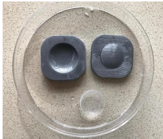
Şekil 2.4. Hidrojel kontakt lens malzemesi örneği ve lens kalıbı.
