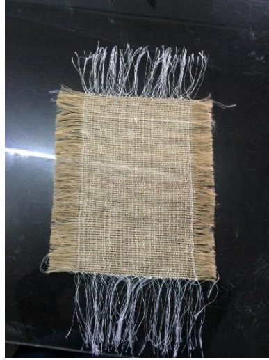
Şekil 3.2 Örölmüş ve kasnaktan çıkarılmış kendir lifi
