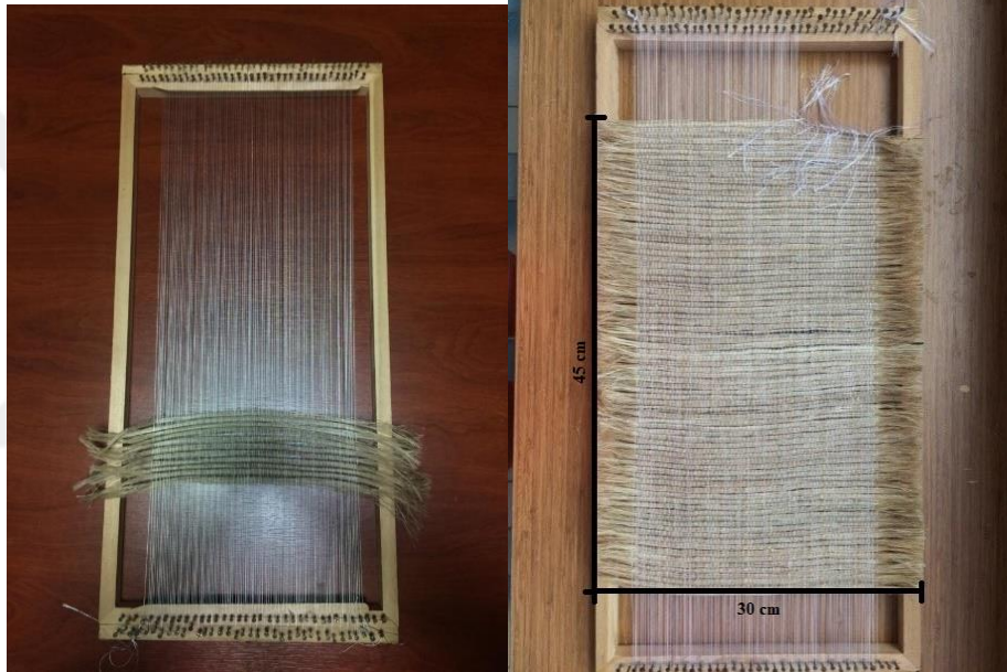
Şekil 3.1 Kaskakta kendir lifinin örülmesi
