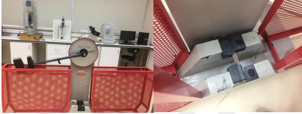
Şekil 4.34 Darbe deney cihazı ve numunenin yerleşimi
