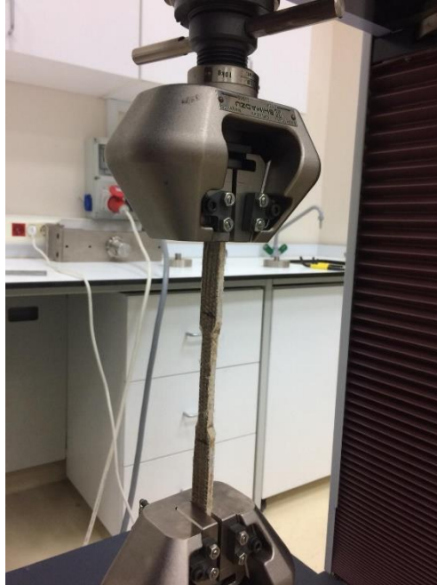
Şekil 4.1 Çekme testinin yapılışı
