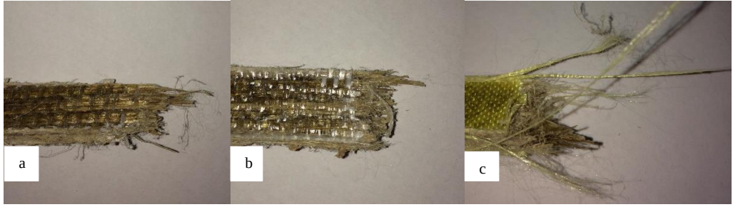
Şekil 4.3 Numune 1(a), Numune 2(b) ve Numune 3(c)'ün çekme testi yaptıktan sonraki kırık yüzeyleri
