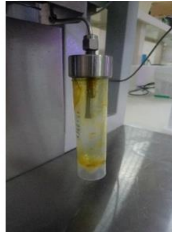
Şekil 3.11. SFE cihazı ve numunenin ekstraksiyonu sonucu elde edilen ekstrakt
