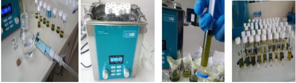
Şekil 3.8. Ultrasonik banyo kullanılarak gerçekleştirilen UAE için işlem aşamaları
