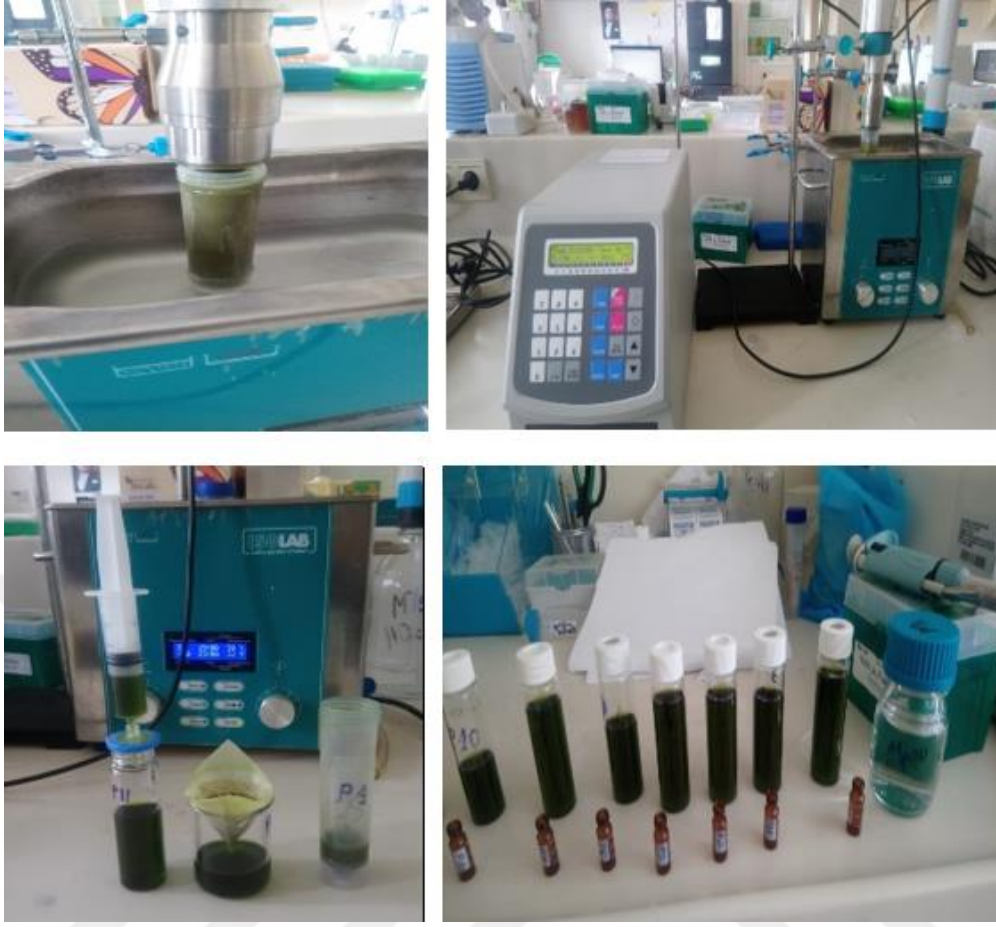
Şekil 3.9. Ultrasonik prob kullanılarak gerçekleştirilen UAE için işlem aşamaları
