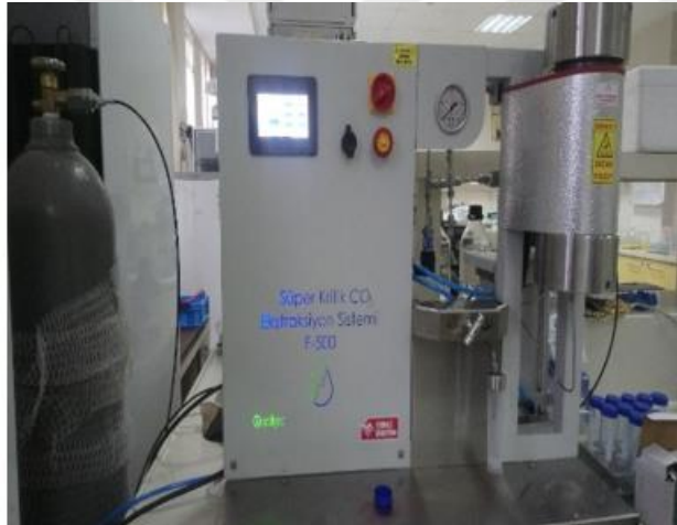
Şekil 3.11. SFE cihazı ve numunenin ekstraksiyonu sonucu elde edilen ekstrakt
