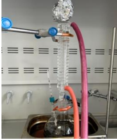
Görsel 11.9. Lignin miktar tayini deney düzeneği
