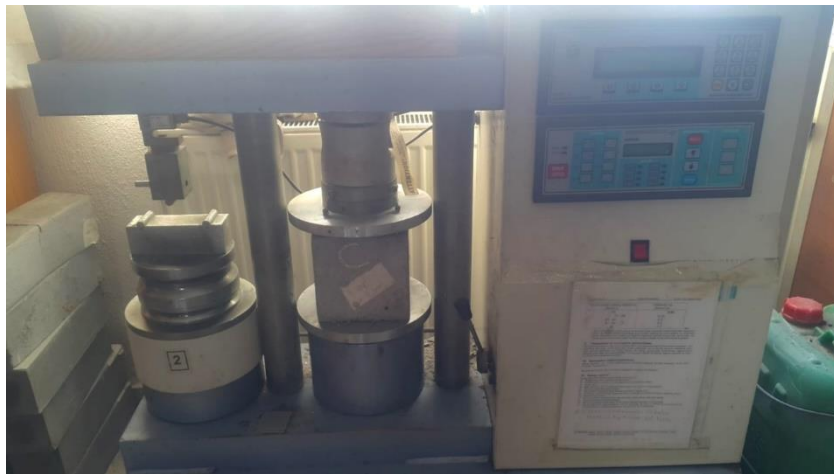
Resim 3. 14 Beton Basınç Presi.
