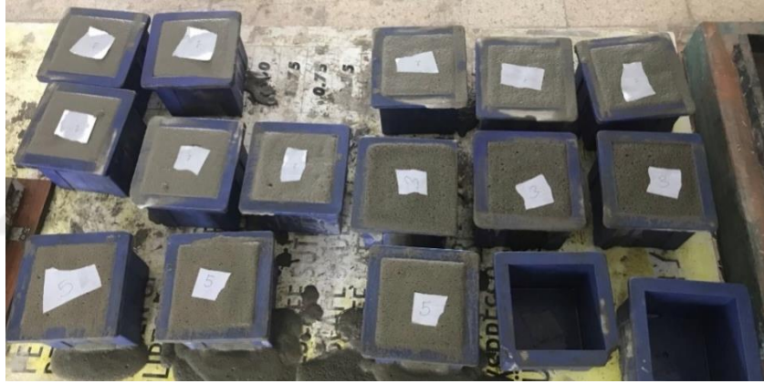
Resim 3. 9 Kalıplanmış ve Etiketlenmiş Numuneler.
