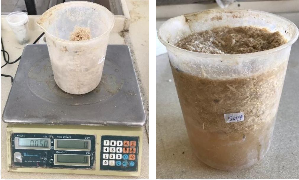
Resim 3. 4 Öğütülmüş ve Tartılmış Kenevir Lifi (a) ve Suda Bekletilmiş Kenevir Lifi (b).
