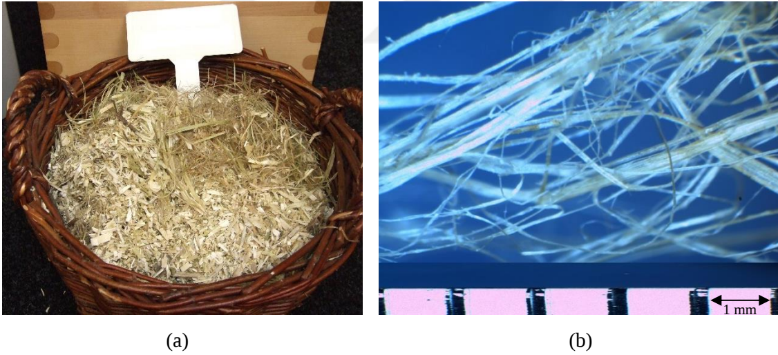
Resim 2. 2 Kenevir Lifi (İnt. Kyn. 4) (a) ve Optik Mikroskop Görüntüsü (b).
