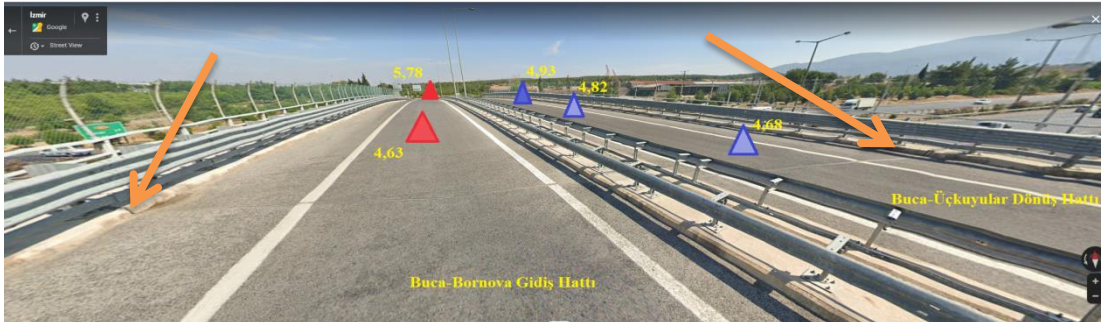
Şekil 101: Uygulamaya Göre Şekil 100’deki Hatalı Dever Noktasının Yol Üzerindeki Görünümü
