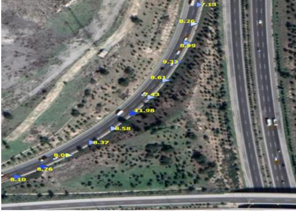
Şekil 102: Uygulamaya Göre Hatalı Dever Noktasının Gözlemi 2
