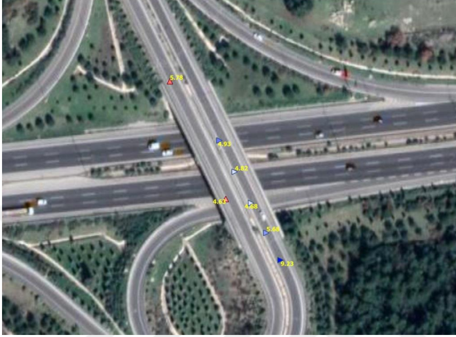
Şekil 100: Uygulamaya Göre Hatalı Dever Noktasının Gözlemi
