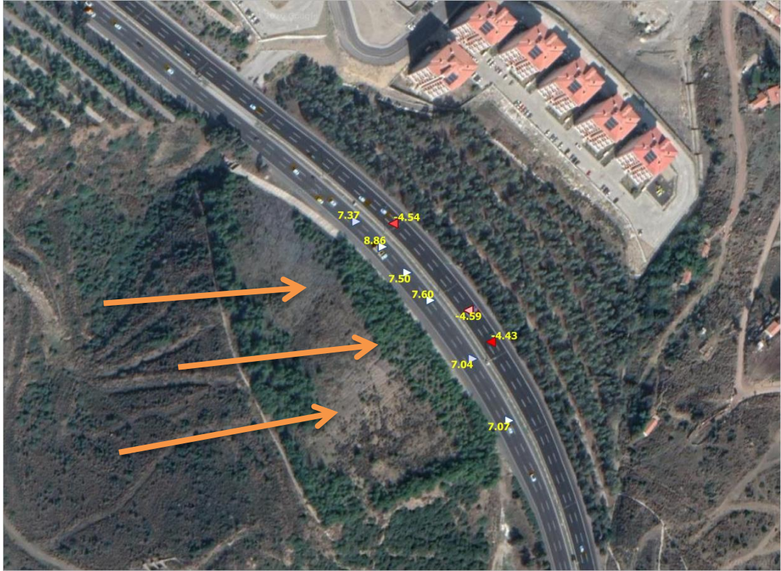
Şekil 108: Uygulamaya Göre Hatalı Dever Noktasının Gözlemi 5
