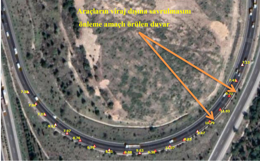
Şekil 106: Uygulamaya Göre Hatalı Dever Noktasının Gözlemi 4
