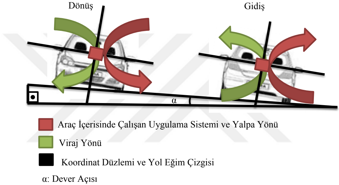
Şekil 86: Örneklem Yol Üzerindeki Taşıtın Yolun Eğimine Göre Gösterimi
