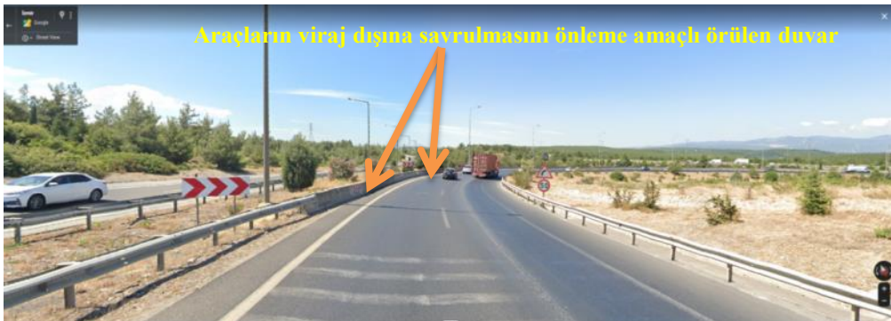
Şekil 107: Uygulamaya Göre 106’daki Hatalı Dever Noktasının Yol Üzerindeki Görünümü 4
