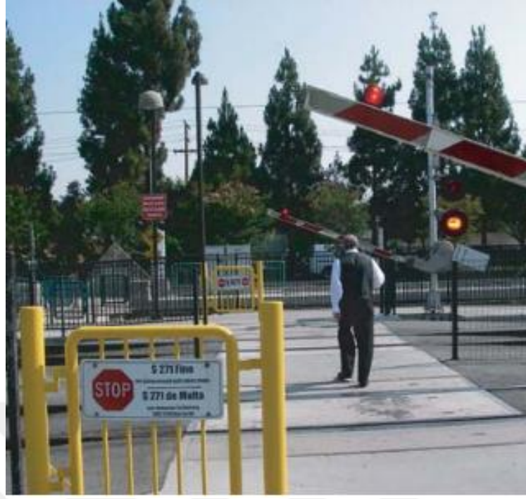
Görsel 4.20. Kuzey Amerika hafif raylı sistem hattında sinyalizasyon ve bariyer kullanımı [13]
