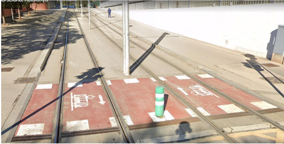
Görsel 4.10. Barcelona tramvay hattında yatay düzlem trafik işareti kullanımı (http-10)
