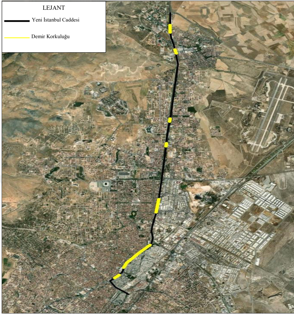
Şekil 5. 37. Çalışma alanında yapılmış demir korkuluklar (Kişisel Arşiv, 2020)
