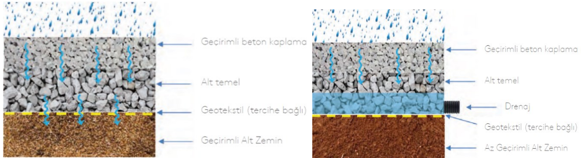
Şekil 2.17: Geçirimli beton kaplamalarının tasarımı (URL-10'dan düzenlenmiştir).
