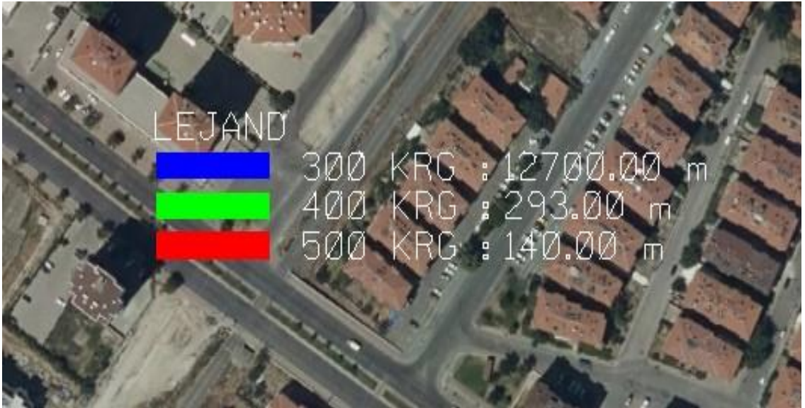
Şekil 3.20. Proje boru çap ve metraj detayı
