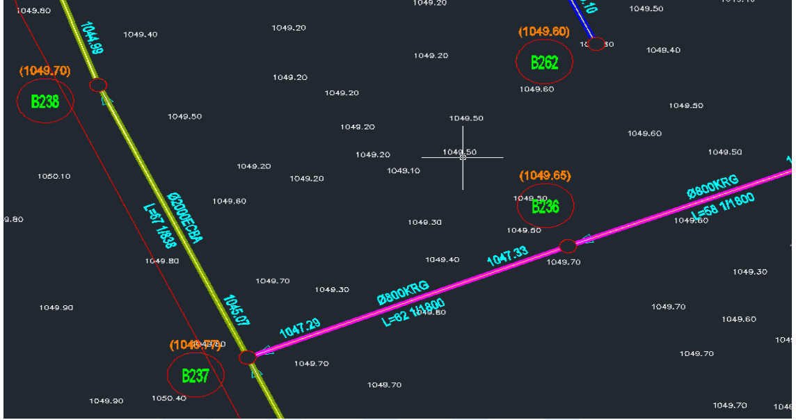
Şekil 3.3. Boru akış yönleri ve muayene bacalarının detaylı görünümü
