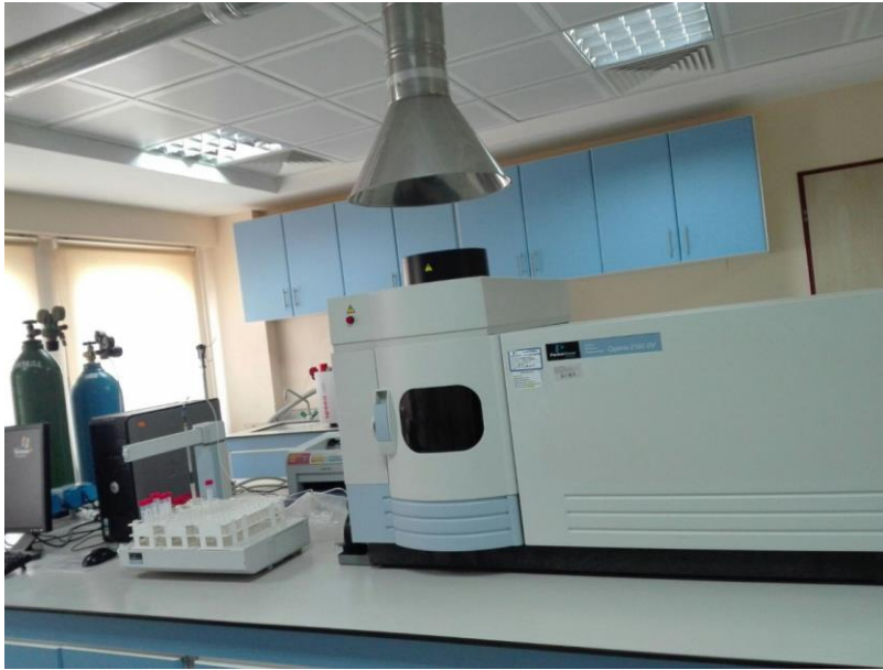
Fotoğraf 1.2. Analizlerde kullanılan ICP-OES cihazı
