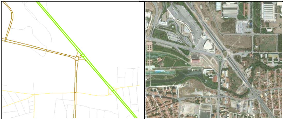
Şekil 4.4. Sayısal haritanın güncelleme ihtiyacının uydu görüntüsü ile tespiti örneği
