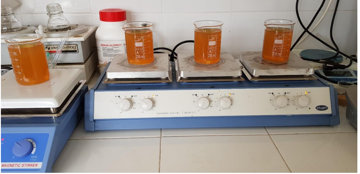
Şekil 4.4. KAAT Çıkış Suyuna H_2O_2 İlavesi Sonrası Karıştırma İşlemi
