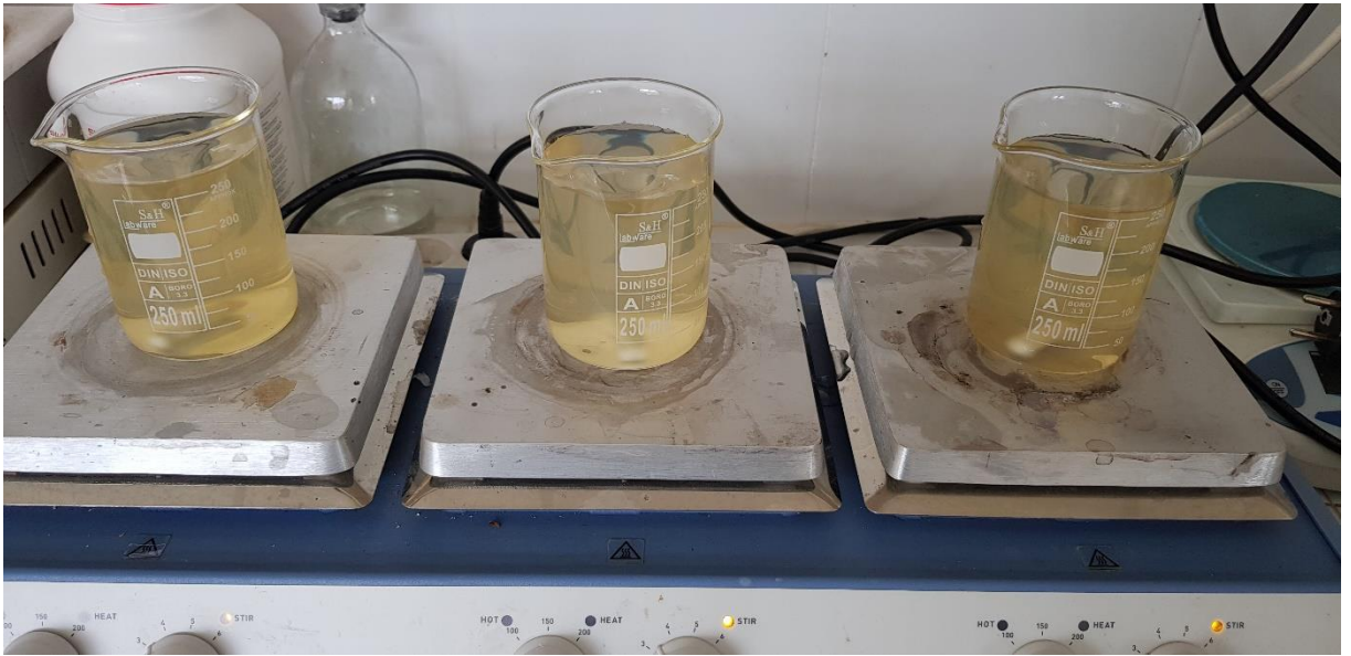
Şekil 4.3. KAAT Çıkış Suyuna FeSO 4 ·7H 2 O İlavesi Sonrası Karıştırma İşlemi
