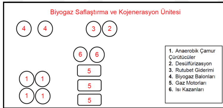
Şekil 3.16. Biyogaz saflaştırma ve kojenerasyon ünitesi vaziyet planı.
