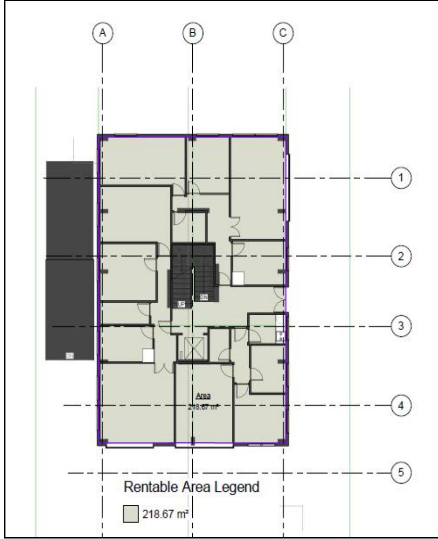
Şekil 6.9 : BIM uygulama planı doğrultusunda alternatif proje denemeleri otomatik brüt alan hesaplamaları.
