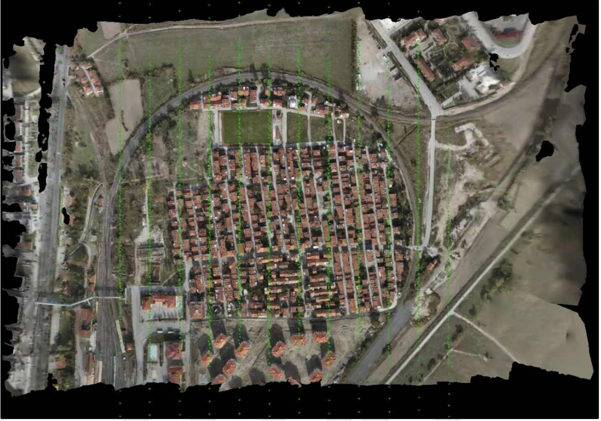
Şekil 2. 21. Uçuş planı ve görüntü alım noktaları
