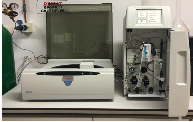
Şekil 5.8. İyon kromatografi cihazı
