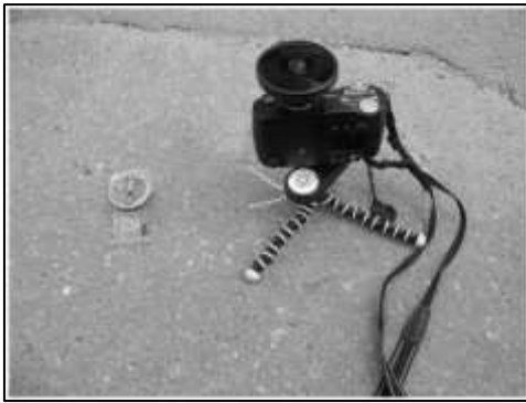
Şekil 2.12. Balıkgözü lens ile saha çalışması (Hammerle ve ark. 2011)
