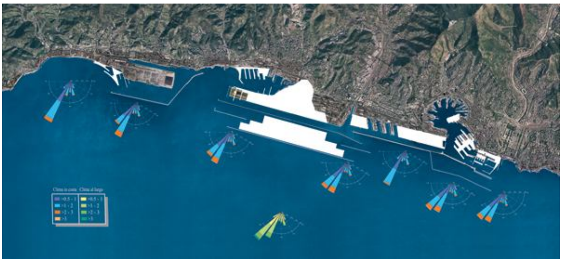
Şekil 3.54 Offshore İçin Kıyı Dalga Hareket Analizi 1 ( http://www.porto.genova.it )
