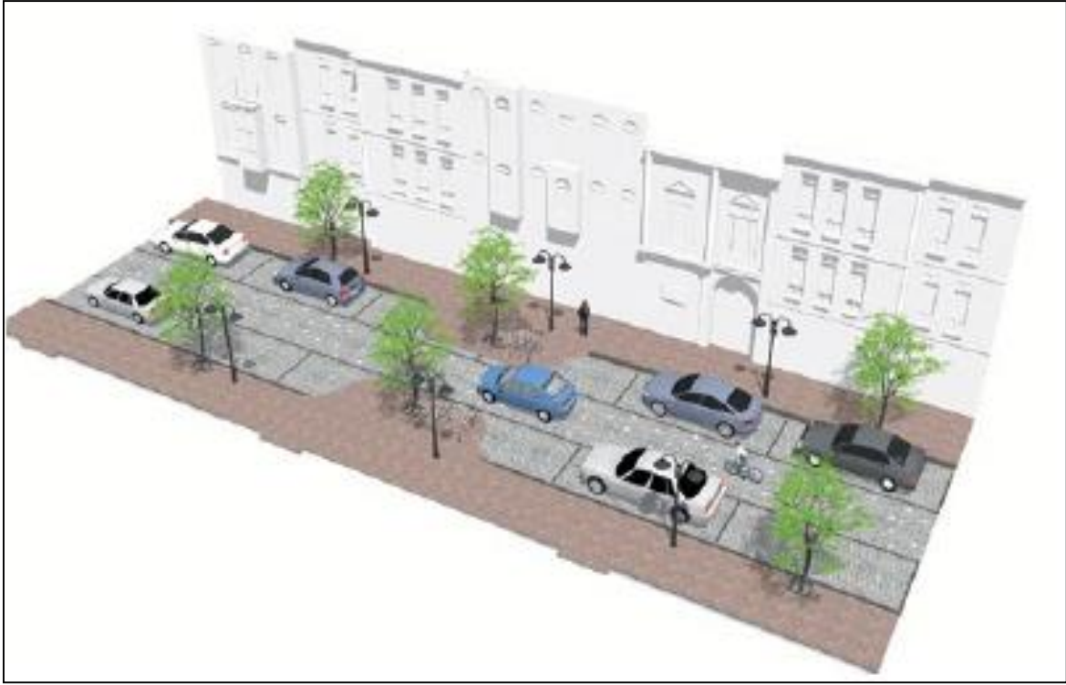
Şekil 3.10. Yol kenarını daraltma örneği
