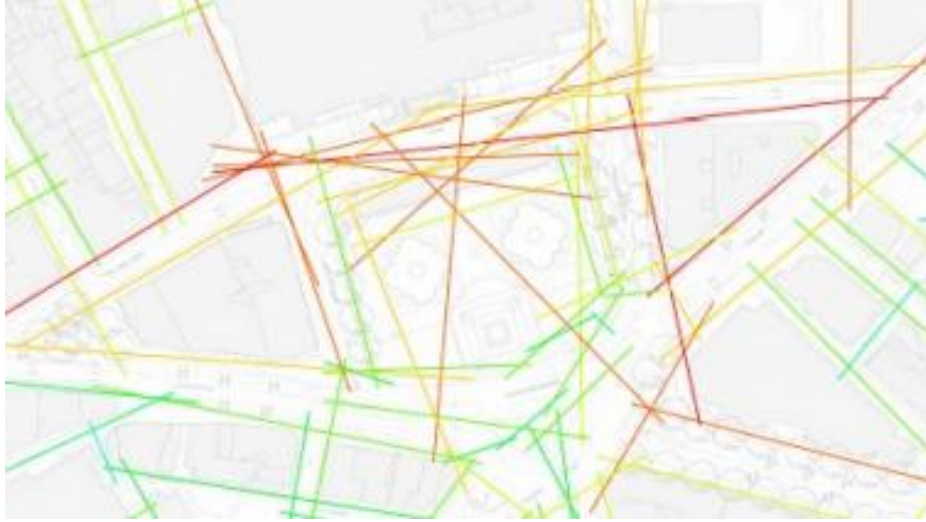
Şekil 3.5. Trafalgar meydanının tasarımının öncesi ve sonrasında meydana hareketliliği gösteren ulaşılabilirlik analizi (Yıldırım,2018)
