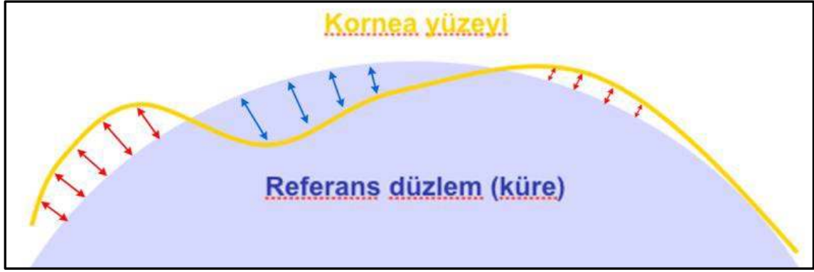
Şekil 3.7. Yükseklik haritasında en iyi uyan kürenin kullanımı (Sarı çizgi kornea yüzeyini, mavi küre referans düzlemi göstermekte. Kornea yüzeyinin referans düzlem üzerinde kalan alanları kırmızı, altında kalan alanlar ise mavi ok ile işaretlenmiştir) (63).
