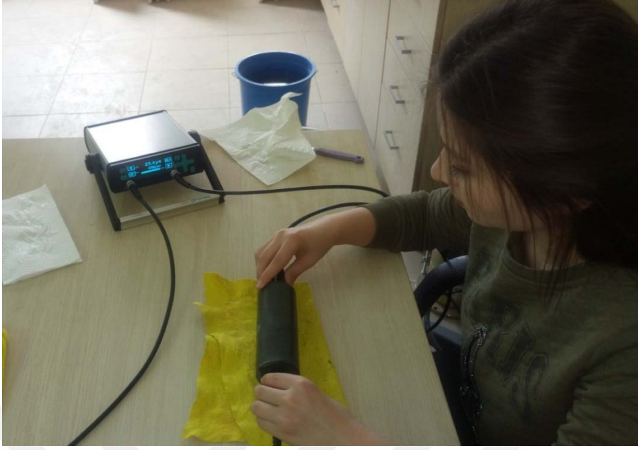
Şekil 2.8. Boyuna dalga hızı ( V_p ) ölçümü
