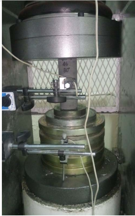
Şekil 2.11. Tek eksenli sıkışma dayanımı deneyi
