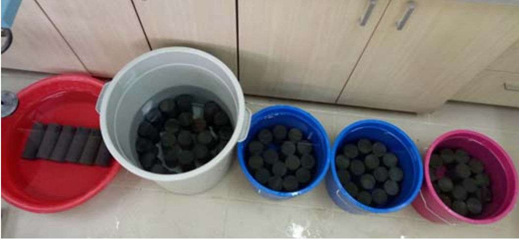
Şekil 2.7. Örneklerin laboratuvar ortamında doymun hale getirilmesi
