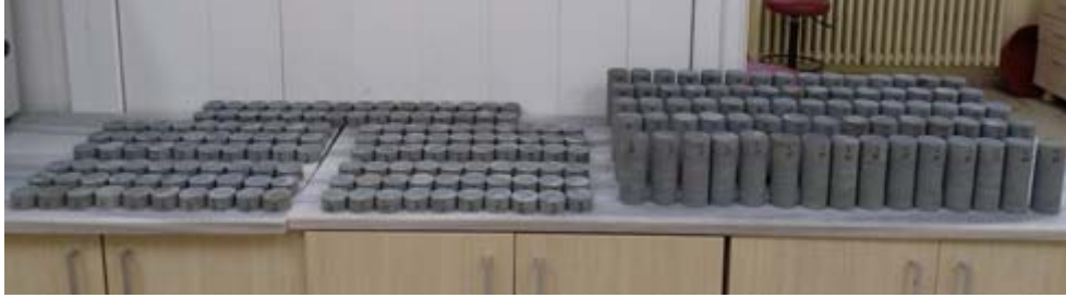
Şekil 2.5. Farklı yönelim açılarında ( \beta ) hazırlanmış karot ve disk örnekleri
