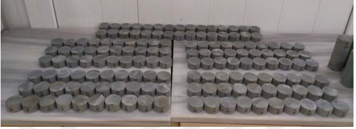
Şekil 2.12. Farklı yönelim açılarında hazırlanan dolaylı (Brazilian) çekilme dayanımı için hazırlanan örnekler
