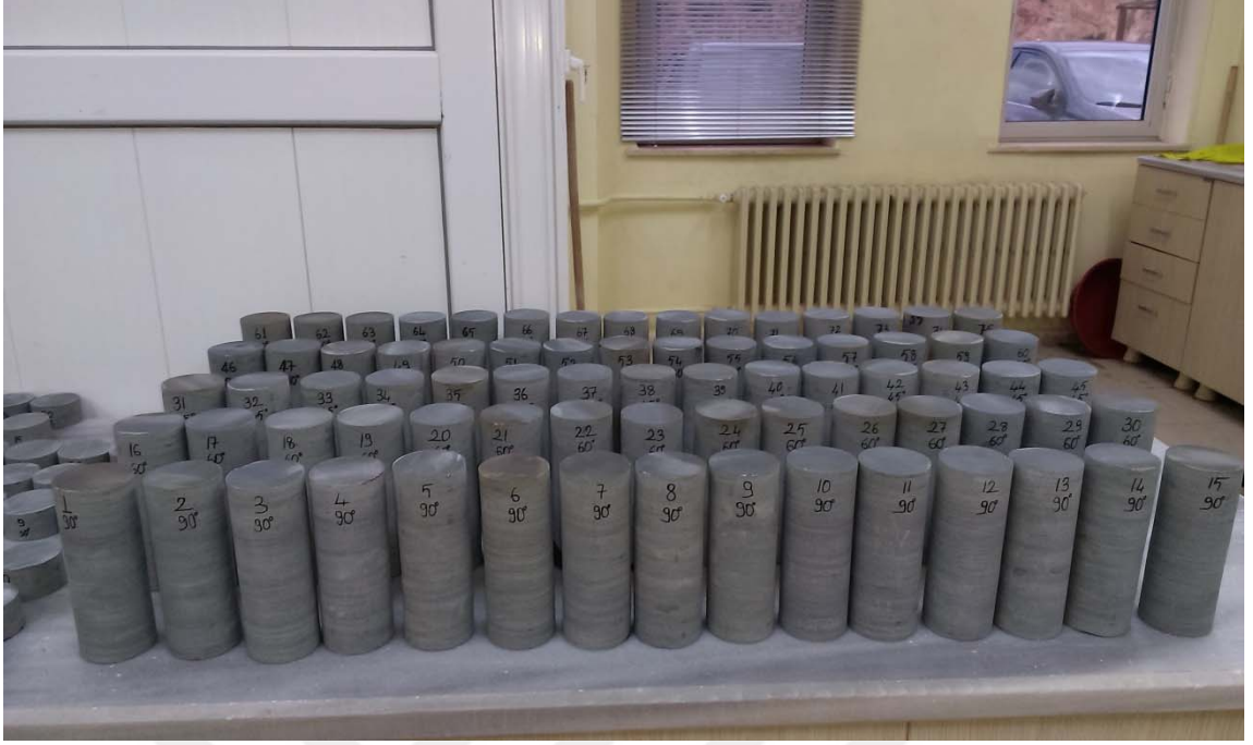
Şekil 2.10. Farklı yönelim açılarında hazırlanan tek eksenli sıkışma dayanımı deneyi örnekleri
