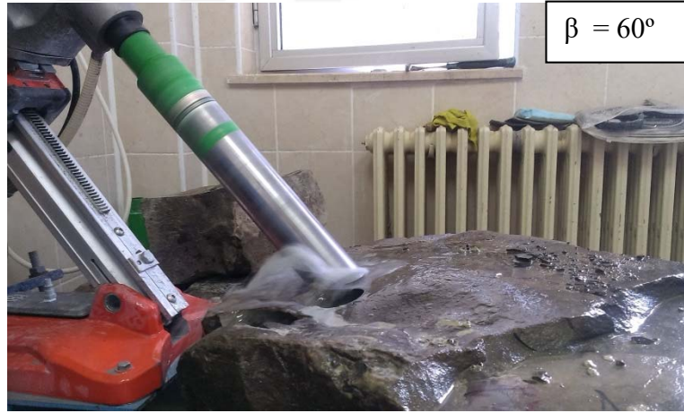
Şekil 2.2. Yönlü karot alma işlemi
