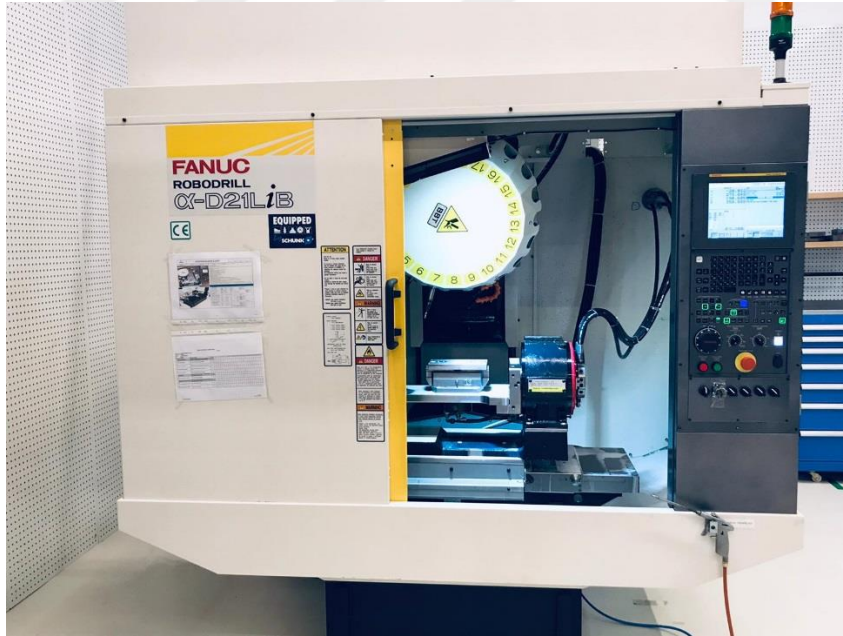
Şekil 2.3. Fanuc ROBODRILL alpha-21DLiB CNC dikey işleme merkezi
