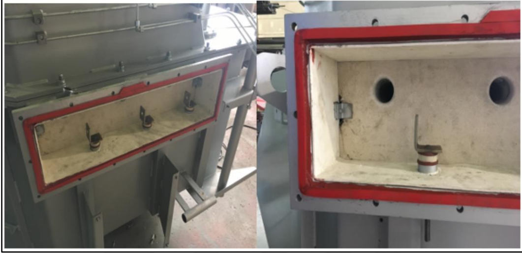
Şekil 4.31 Filtreleme havuzu SiC rezistans terminal yuvalarının kapak görüntüsü
