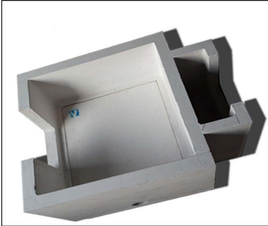
Şekil 4.1 Sürekli dökümde kullanılan filtreleme kutusu görseli (Anonim, 2021)
