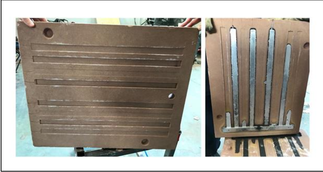
Şekil 5.1 8 kollu akışkanlık testi kalıbı
