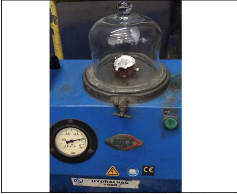
Şekil 5.4 Vakum altında katılaşma testi cihazı, HYDRALVAC 1000
