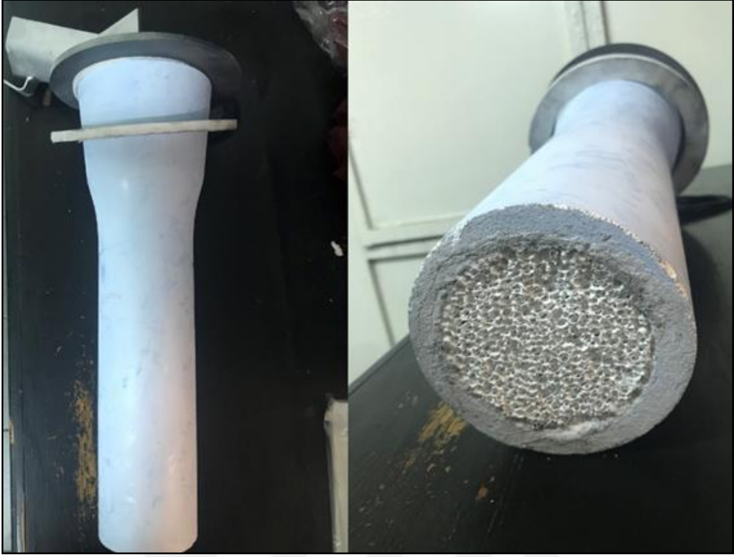
Şekil 4.10 Değiştirilmiş ve filtre takılmış dozaj tüpü görüntüsü
