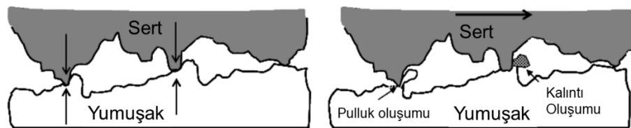
Şekil 4.13. Aşındırıcı aşınma mekanizmasının şematik gösterimi. Sert yüzey pürüzlü yapının yumuşak yüzeyle teması, sert yüzey pürüzlü yapının yumuşak yüzeyden malzemeyi sürmesi ve kesmesi [203].
